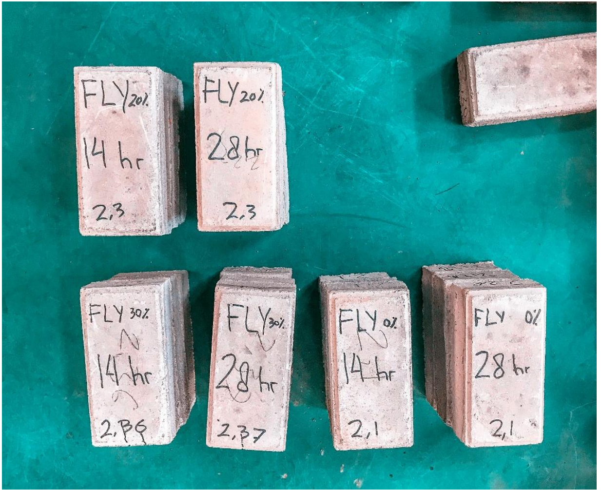
Gambar 15. Paving Block siap untuk di uji tekan
