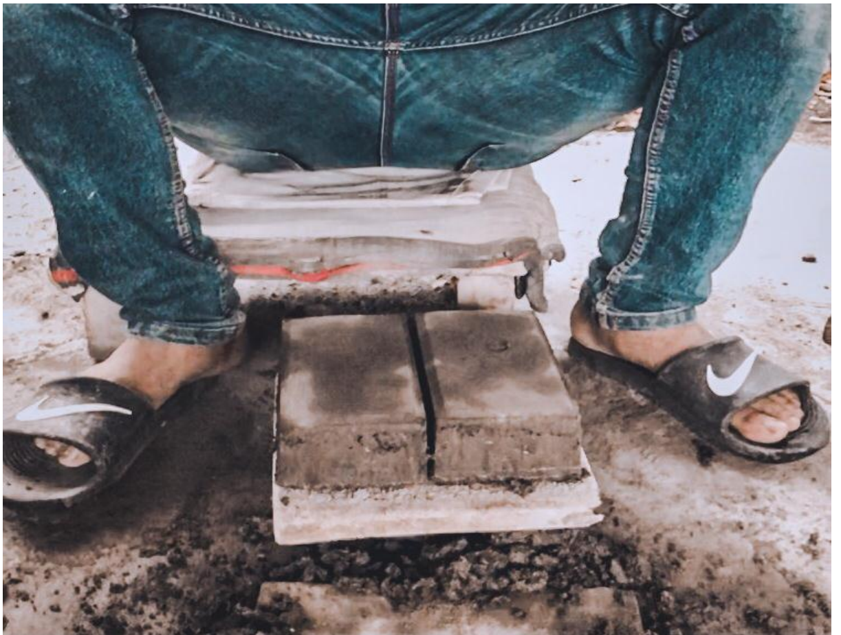
Gambar 11. Paving block telah selesai dicetak
