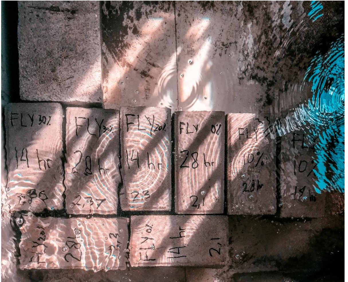
Gambar 13. Setelah kering, dilakukan perawatan serta uji resapan air paving block .
