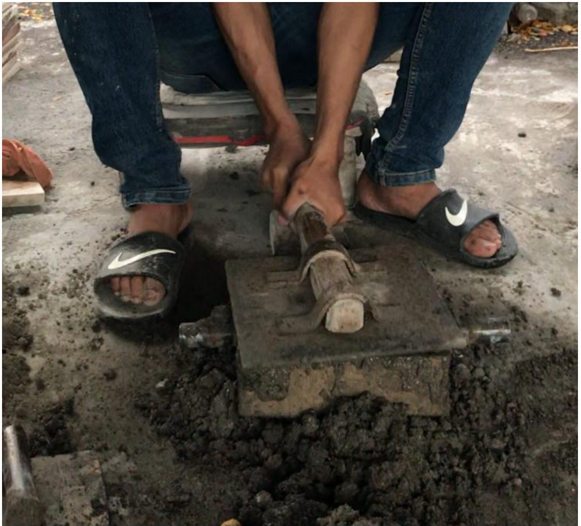
Gambar 10. Pemerataan campuran dengan cara menumbuk
