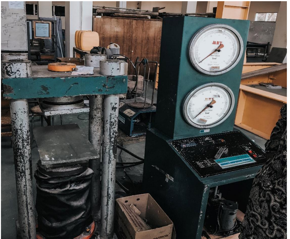
Gambar 16. Mesin uji kuat tekan
