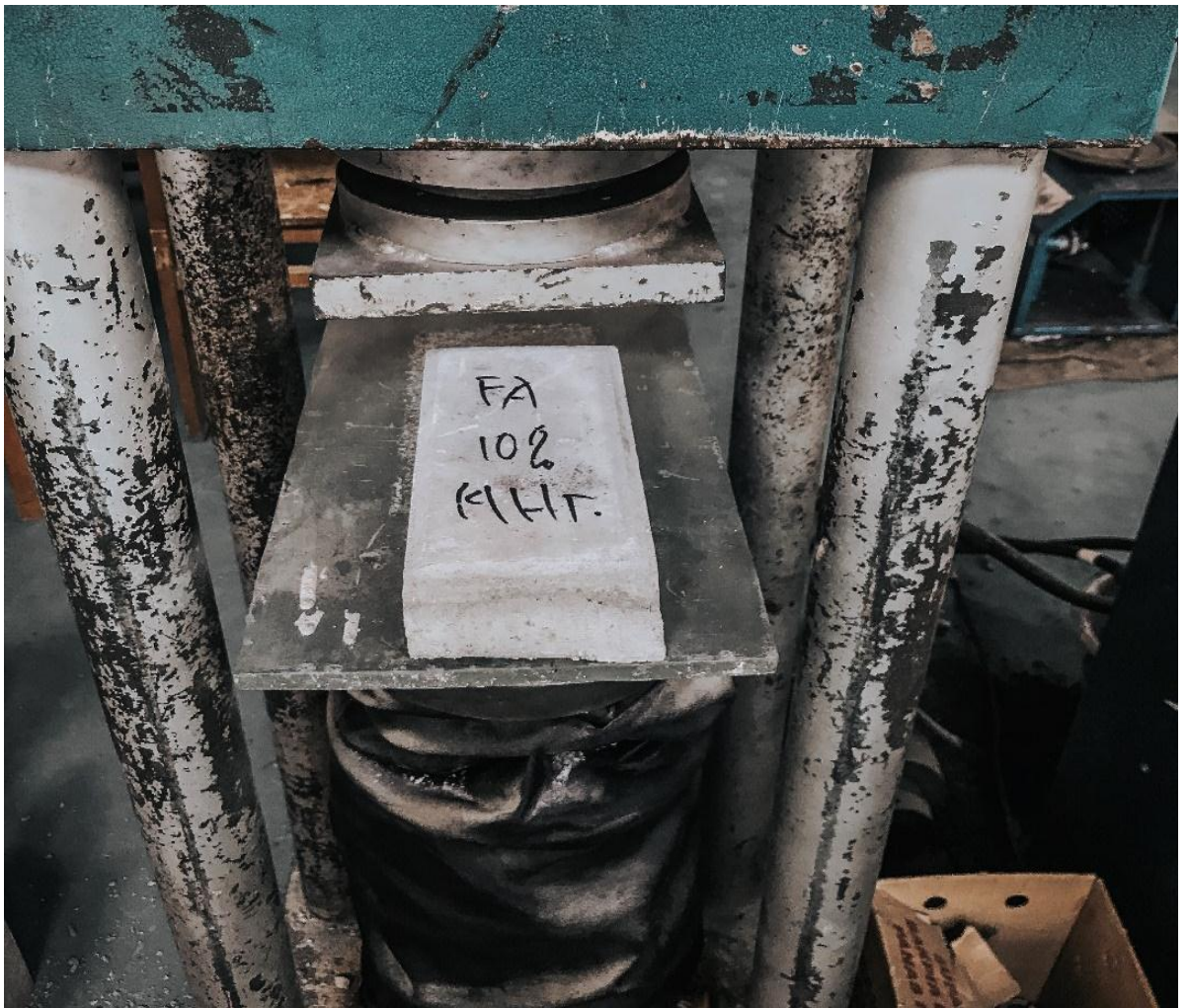
Gambar 17. Uji Tekan Paving Block ( Laboratorium Teknik Sipil Unissula)
