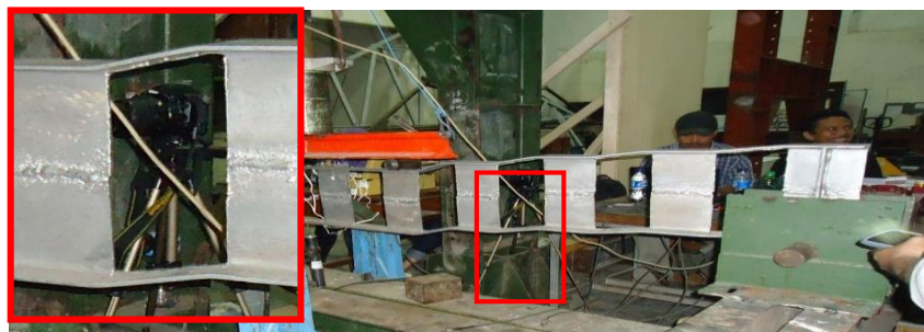
Gambar 1.2. Keruntuhan Vierendeel yang Terjadi Pada Balok Castellated Bukan Segi Empat (Oliveira, 2012)
