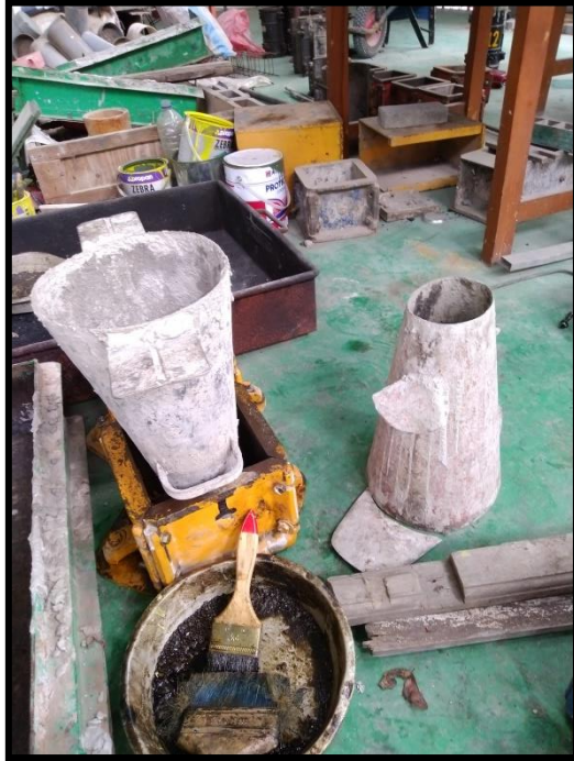
Persiapan alat uji slump
