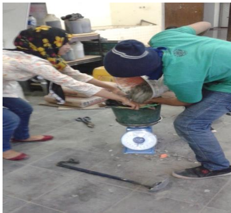
Gambar 2. Penimbangan semen, serat baja dan abu batu untuk membuat benda uji di laboratorium Konstruksi dan Bahan Fakultas Teknik Unissula Semarang
