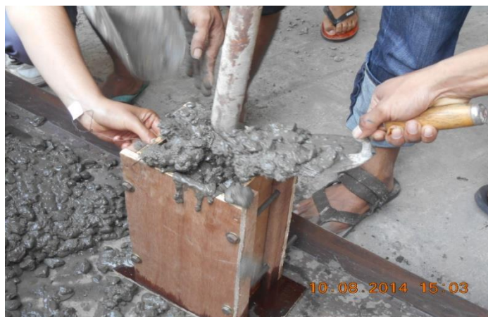
Gambar 6. Pengecoran dan pepadatan benda uji persegi
