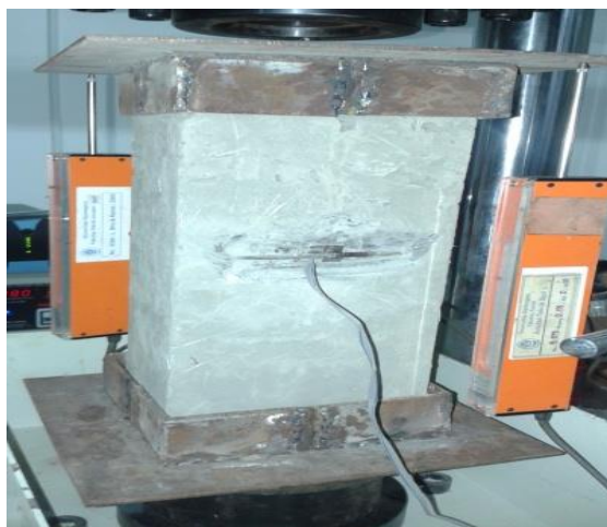
Gambar 9. Pemasangan LVDT pada benda uji sebelum dites dengan hydraulic concrete testing machine kapasitas 1800 kN
