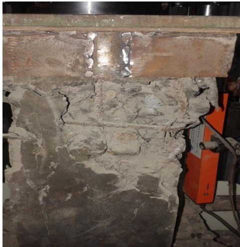
Gambar 14. Inti beton benda uji yang mengalami keruntuhan setelah melampaui beban puncak
