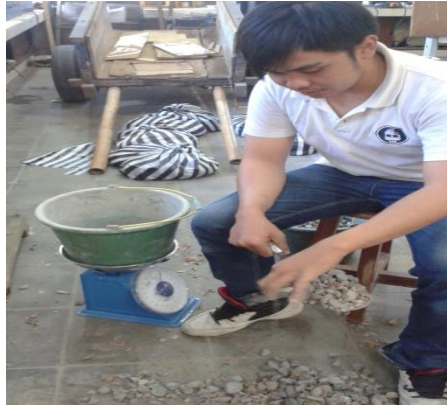
Gambar 1. Penimbangan kerikil dan pasir untuk membuat benda uji di laboratorium Konstruksi dan Bahan Fakultas Teknik Unissula Semarang
