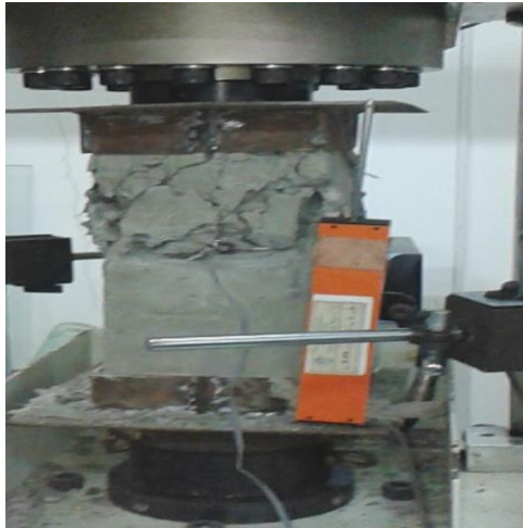
Gambar 13. Keruntuhan yang mulai terjadi pada benda uji
