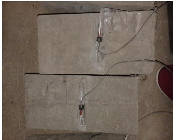
Gambar 8. Pemasangan strain gauge pada benda uji untuk mengukur regangan yang terjadi
