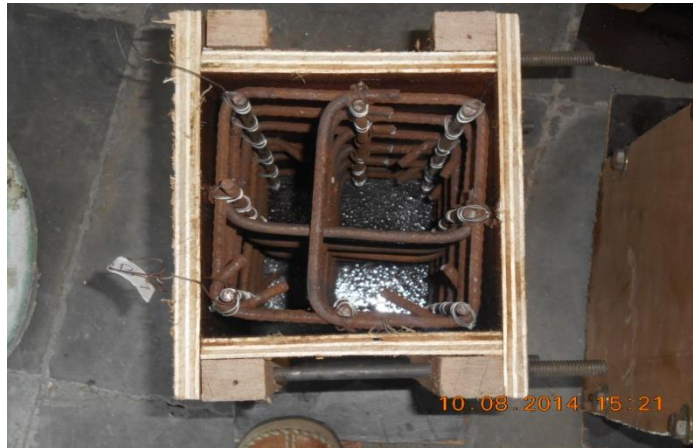
Gambar 5. Benda uji persegi dengan konfigurasi tulangan B
