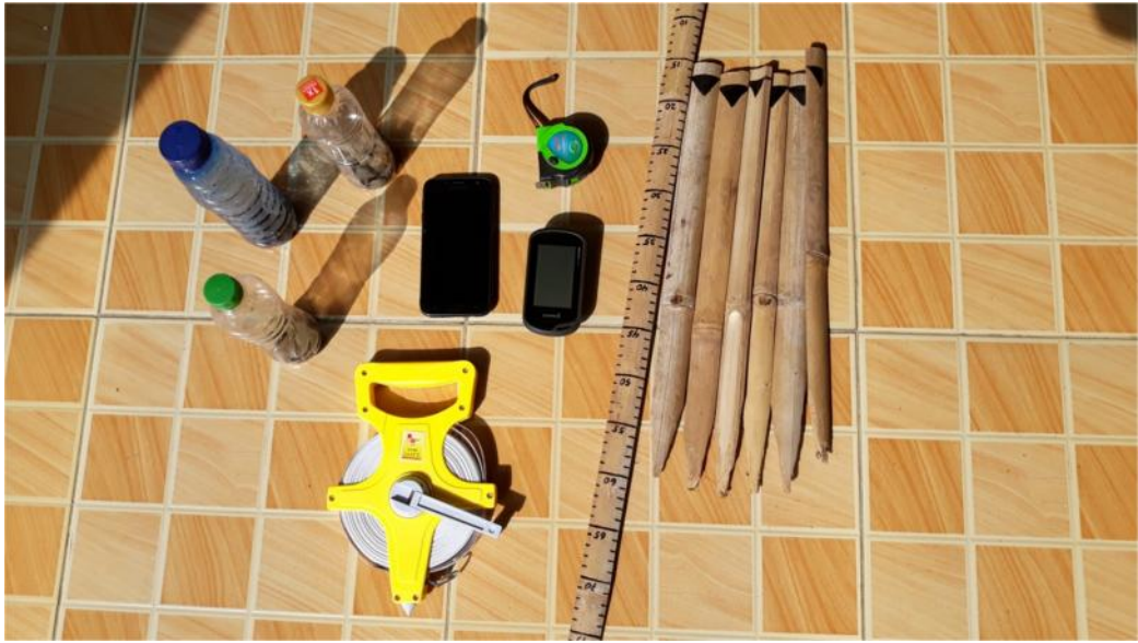
Foto 3. Peralatan Survey Pengukuran Debit
