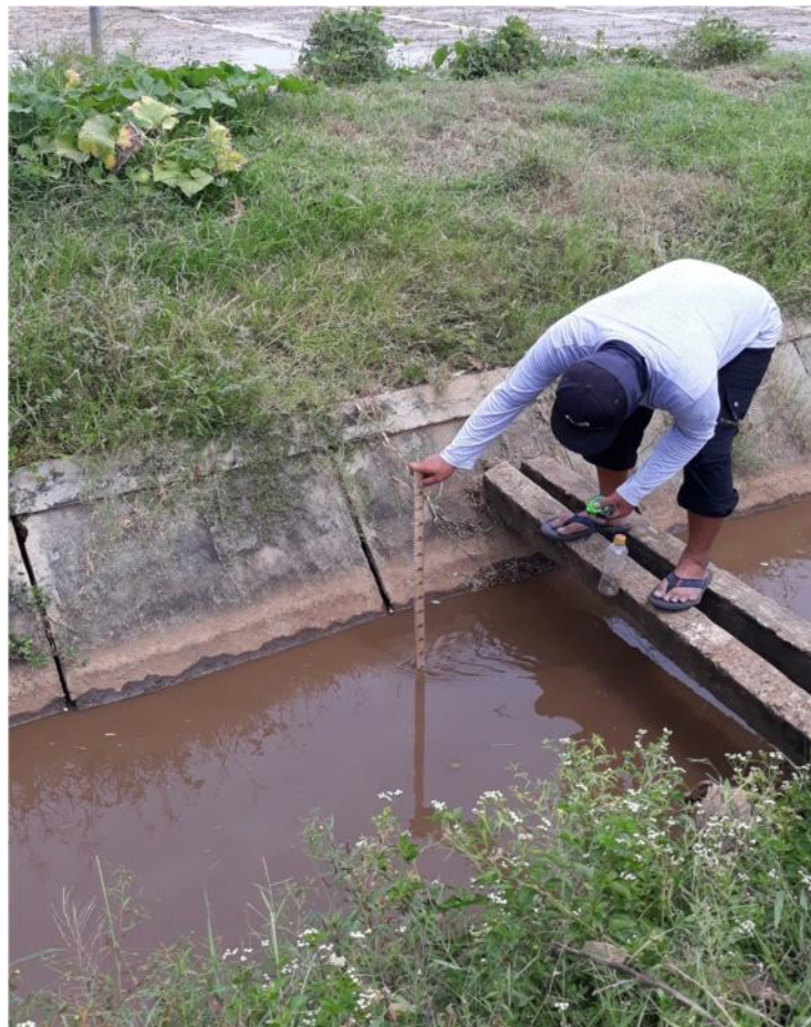
Foto 4. Pengukuran Kedalaman Saluran
