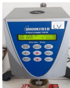
Keterangan: Uji viskositas krim ekstrak daun kelor
