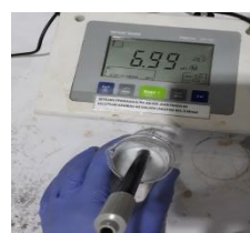
Keterangan: Uji pH basis
