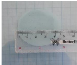
Keterangan: Uji daya sebar basis
