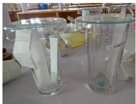
Keterangan: Penentuan bercak noda pada lempeng KLT
