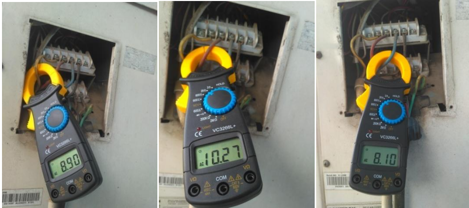
Pengukuran Arus outdoor saat kompresor on pada suhu 20°C.
