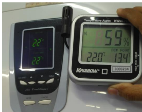
Pengecekan suhu ruangan pada saat setting suhu 22°C.
