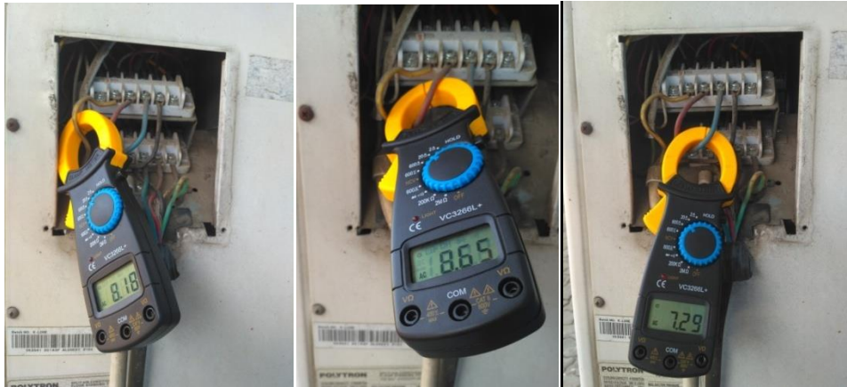
Pengukuran Arus outdoor saat kompresor on pada suhu 26°c.
