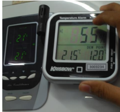
Pengecekan suhu ruangan pada saat setting suhu 21 °c.
