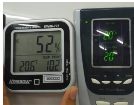
Pengecekan suhu ruangan pada saat setting suhu 20 °c.
