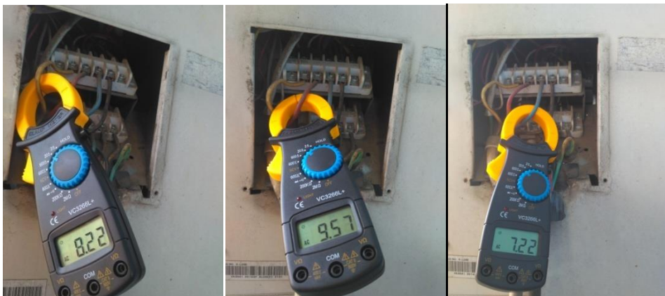
Pengukuran Arus outdoor saat kompresor on pada suhu 25°c.
