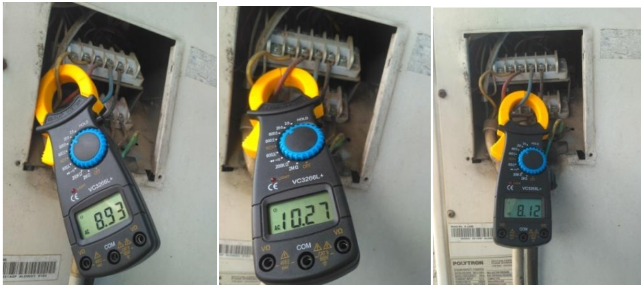
Pengukuran Arus outdoor saat kompresor on pada suhu 19 °c.
