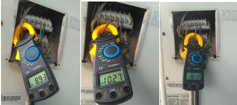
Pengukuran Arus outdoor saat kompresor on pada suhu 18 °c.
