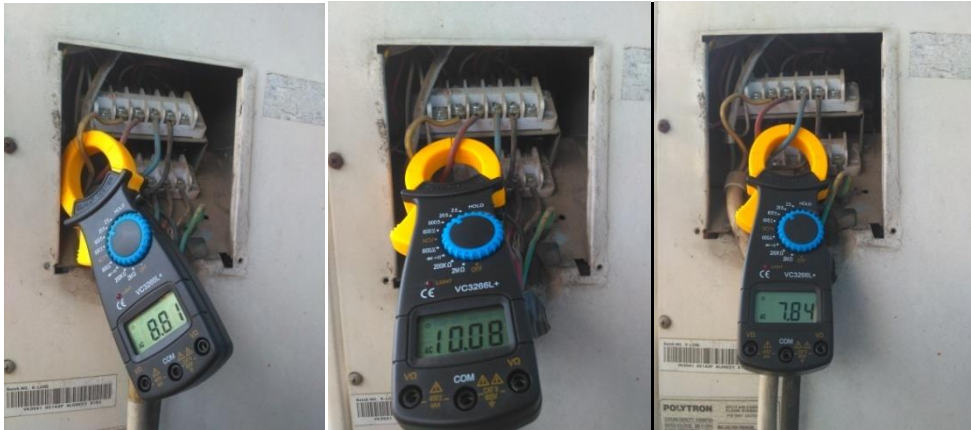
Pengukuran Arus outdoor saat kompresor on pada suhu 22°C.
