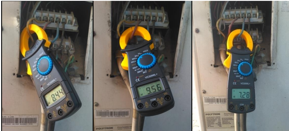
Pengukuran Arus outdoor saat kompresor on pada suhu 24°c.
