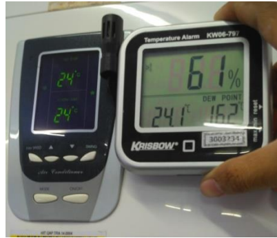
Pengecekan suhu ruangan pada saat setting suhu 24 °c.
