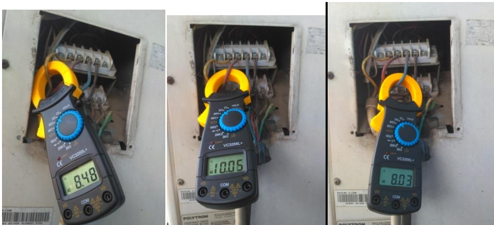
Pengukuran Arus outdoor saat kompresor on pada suhu 23°C.
