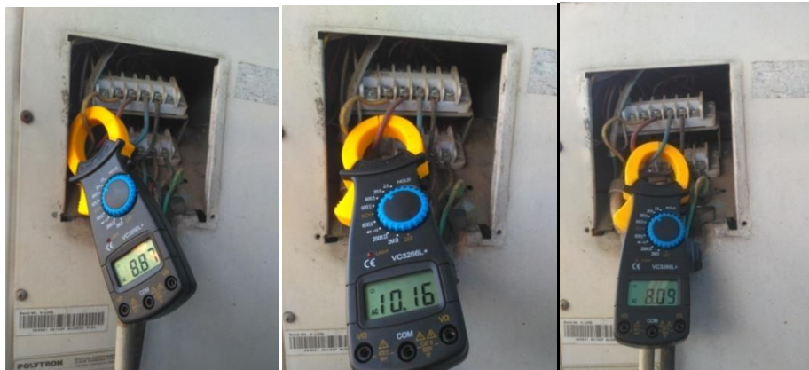
Pengukuran Arus outdoor saat kompresor on pada suhu 21°C.
