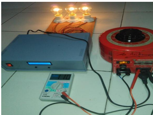
Gambar A.3 Pengujian sensor tegangan dengan Variac Slide Regulator AC
