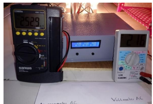
Gambar A.6 Pengukuran daya lampu dengan menggunakan alat ukur standar
