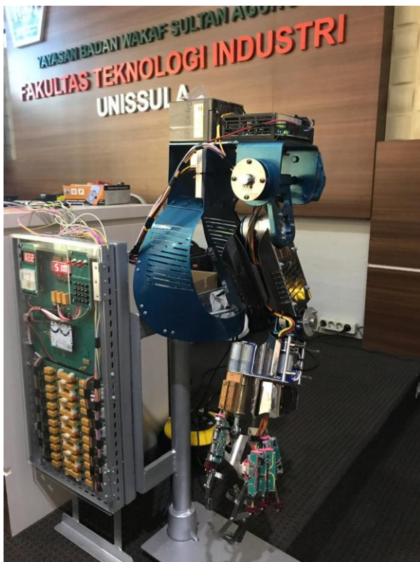
Gambar 5.4 Akuator Tangan Robotik tampak samping
