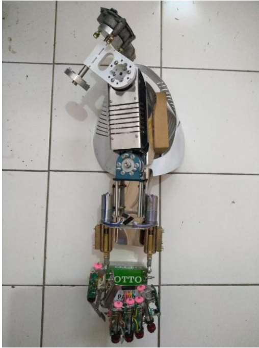
Gambar 5.22 Mekanik seluruh akuator
