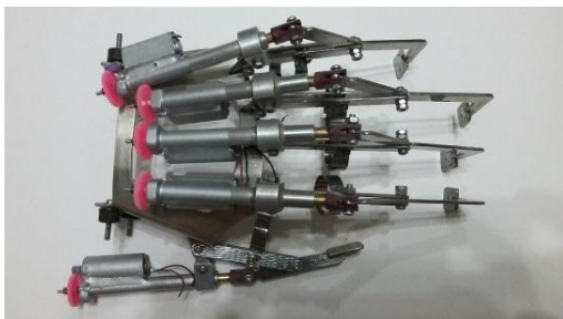
Gambar 5.13 Akuator jari jemari tampak atas
