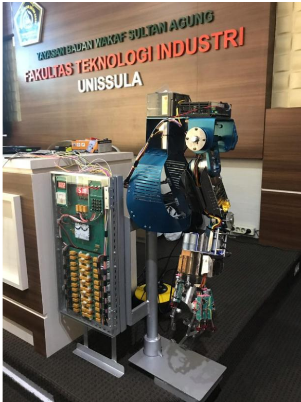
Gambar 5.3 Akuator Tangan Robotik tampak samping
