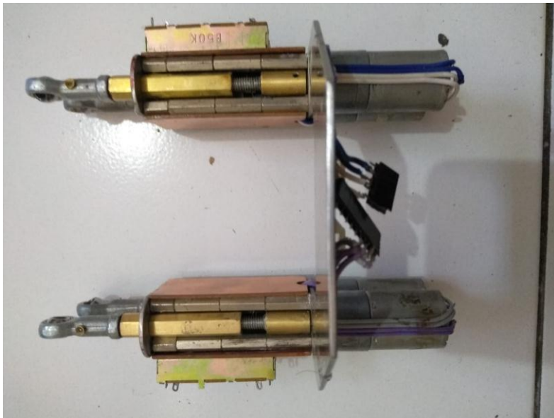
Gambar 5.29 Akuator pergelangan tangan dan motor penggerak
