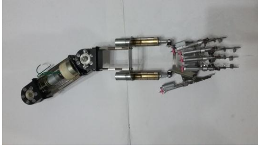
Gambar 5.15 Akuator jari jemari, pergelangan tangan dan Siku tampak atas
