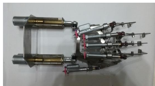
Gambar 5.14 Gabungan akuator jari jemari dan akuator pergelangan tangan
