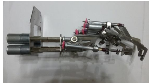
Gambar 5.18 Mekanik jari jemari dan pergelangan tangan
