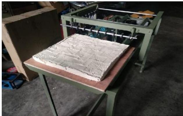
Gambar 1.1 Vh *cutting* tahu manual
