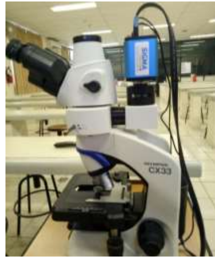
Gambar 14. Mikroskop Olympus CX33 dilengkapi dengan kamera sigma
