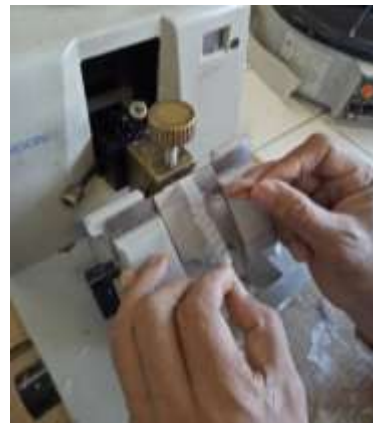
Gambar 12. Pemotongan blok paraffin tulang alveolar
