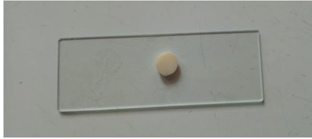
Gambar 4. Sampel fissure sealant berbasis resin setelah dilakukan curing dan polishing
