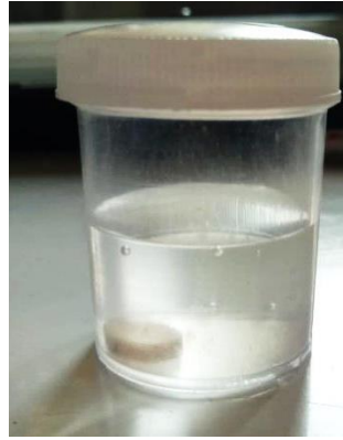
Gambar 8. Perendaman sampel fissure sealant berbasis resin yang telah diaplikasikan APF pada saliva buatan
