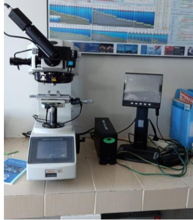
Gambar 11. Pengujian kekerasan sampel fissure sealant berbasis resin dengan menggunakan vickers hardness tester
