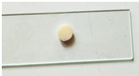
Gambar 7. Sampel fissure sealant berbasis resin setelah diberi aplikasi APF
