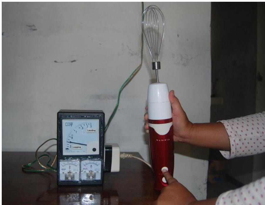
**Foto 4.** Pengukuran  $\cos \phi$  untuk alat rumah tangga
