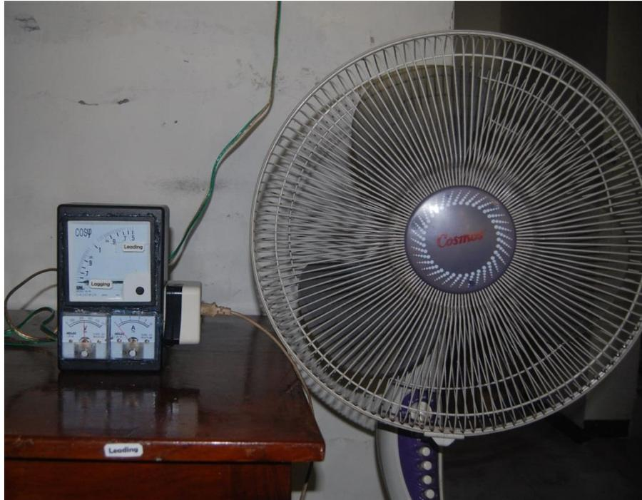
**Foto 3.** Pengukuran  $\cos \phi$  untuk kipas angin
