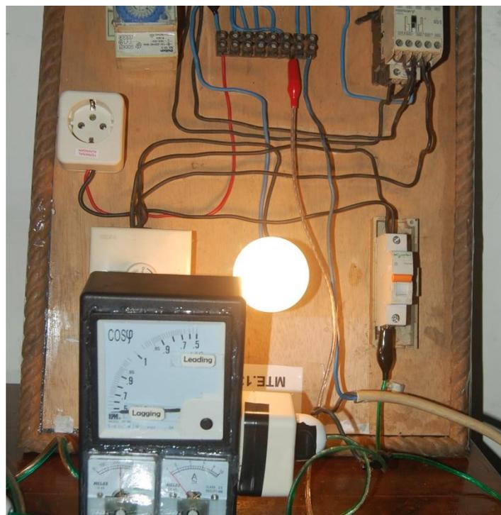
**Foto 6.** Cara memasang alat ukur  $\cos \phi$  pada MCB rumah warga (simulasi)
