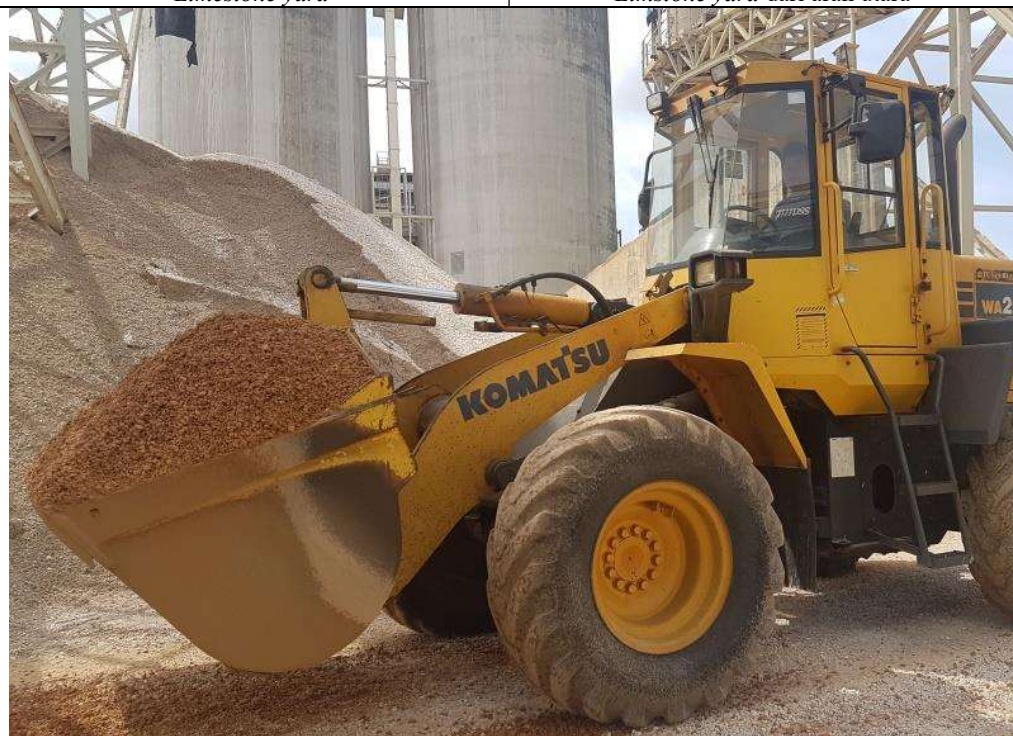
Operator wheel loader WA 200 sedang melakukan pengisian ke silo limestone crusher
