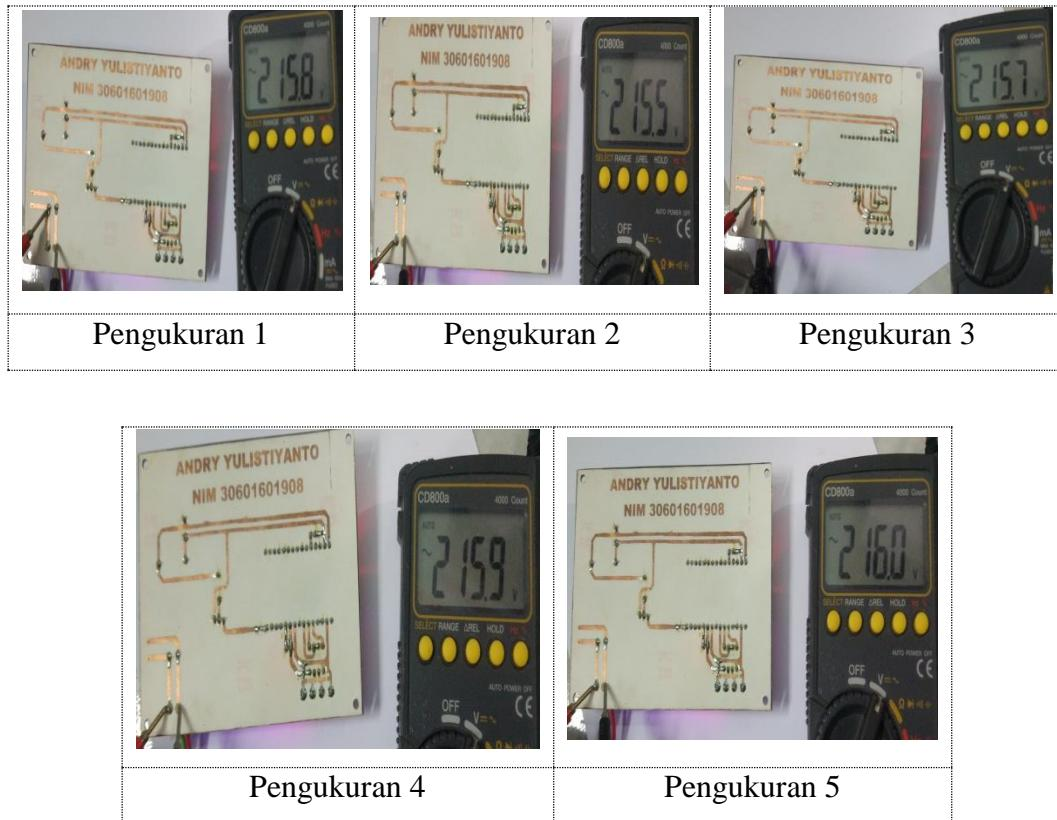
**Gambar 4. 4 Hasil Pengukuran 1,2,3,4, Dan 5 Masukan Catu Daya Modul**
