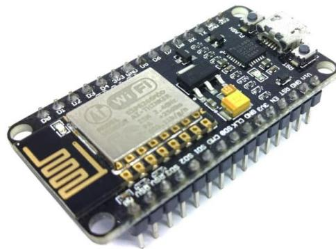
**Gambar 2. 1** Modul ESP 8266 NodeMCU
