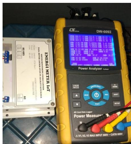
**Gambar 4. 13** Tampilan Pengukuran Power Analyzer Lutron DW-6092
