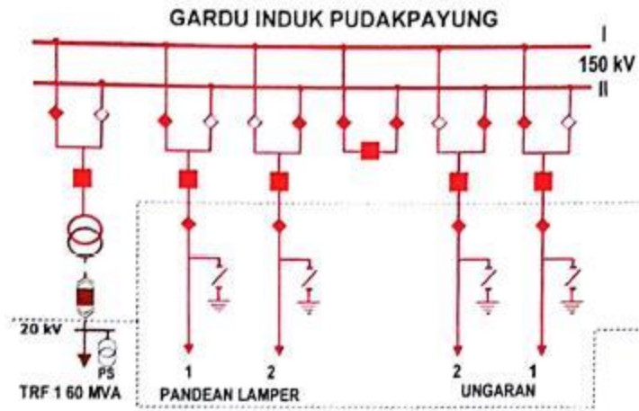
Lampiran 7 single line diagram pada transmisi 150 kV pada GI Puduk Payung
