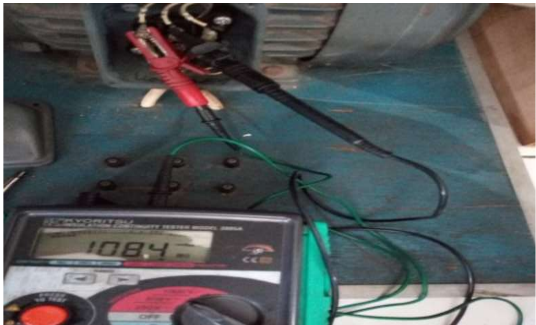
Lampiran 12. Pengujian IR & PI (Polarization Index) pada belitan U_1-V_1 Pada motor TACHO di lab teknik elektro
