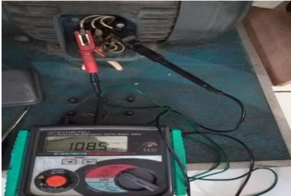
Lampiran 14. Pengujian IR & PI (Polarization Index) pada belitan V_1-Gnd Pada motor TACHO di lab teknik elektro
