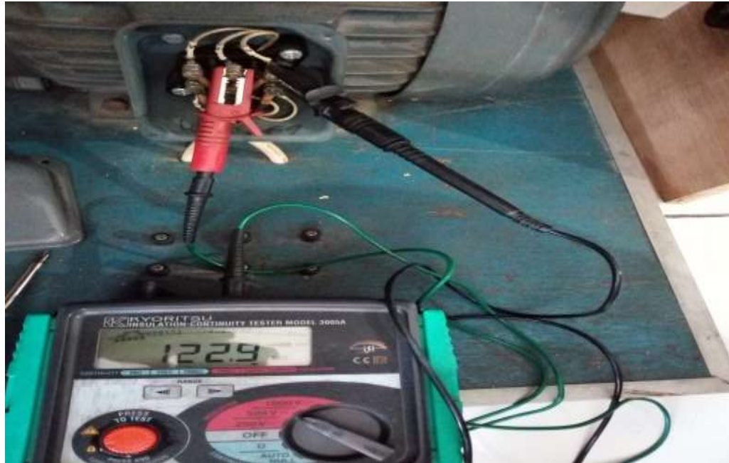
Lampiran 12. Pengujian IR & PI (Polarization Index) pada belitan U_1-V_1 Pada motor TACHO di lab teknik elektro
