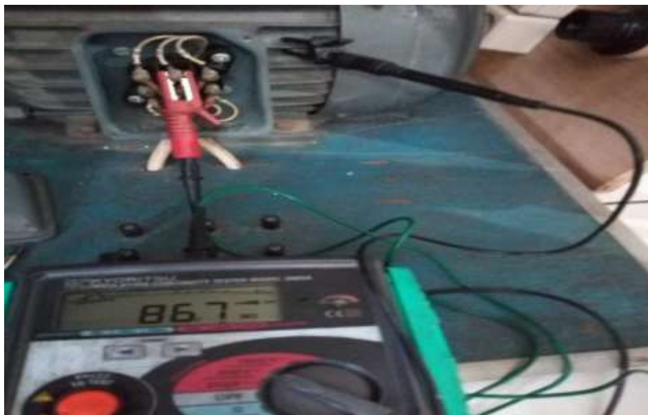
Lampiran 14. Pengujian IR & PI (Polarization Index) pada belitan V_1-Gnd Pada motor TACHO di lab teknik elektro
