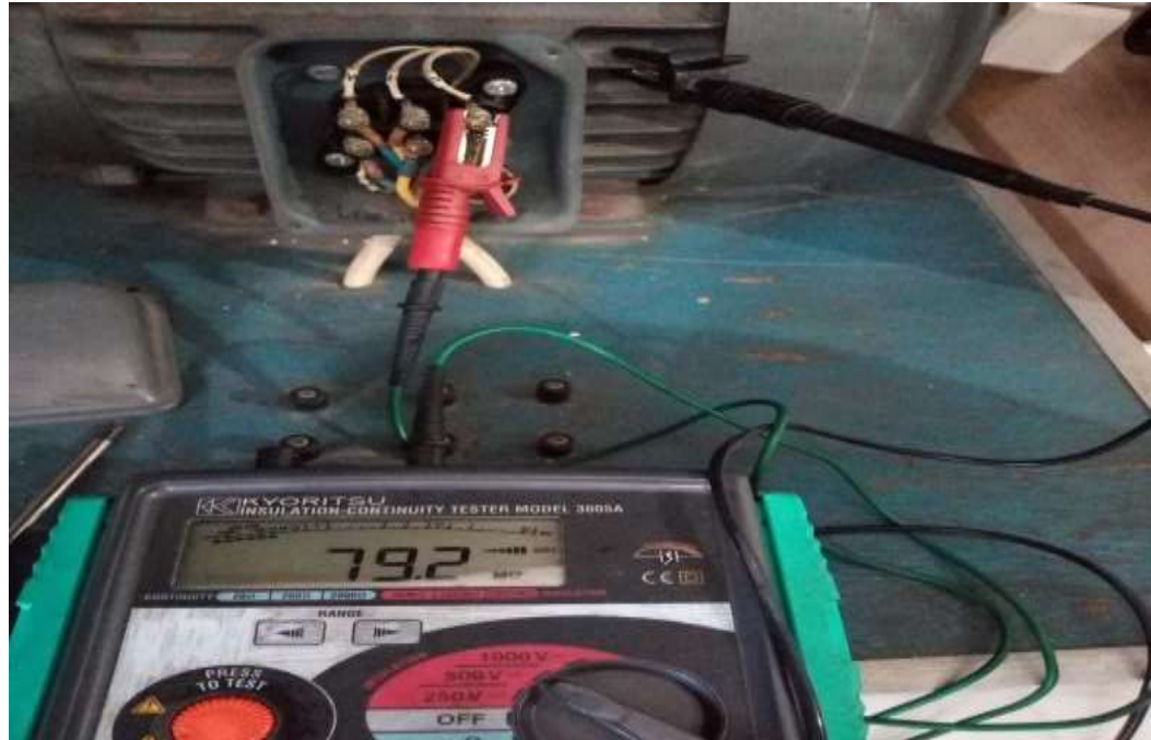
Lampiran 16. Pengujian IR & PI (Polarization Index) pada belitan V_1 -Gnd Pada motor TACHO di lab teknik elektro
