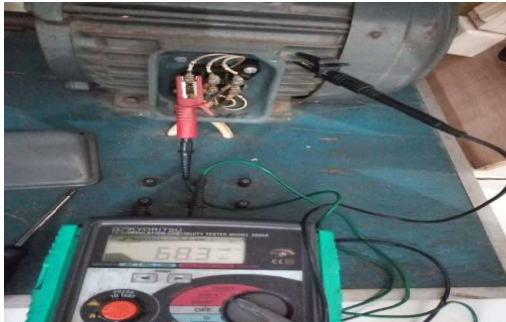
Lampiran 16. Pengujian IR & PI (Polarization Index) pada belitan V_1 -Gnd Pada motor TACHO di lab teknik elektro
