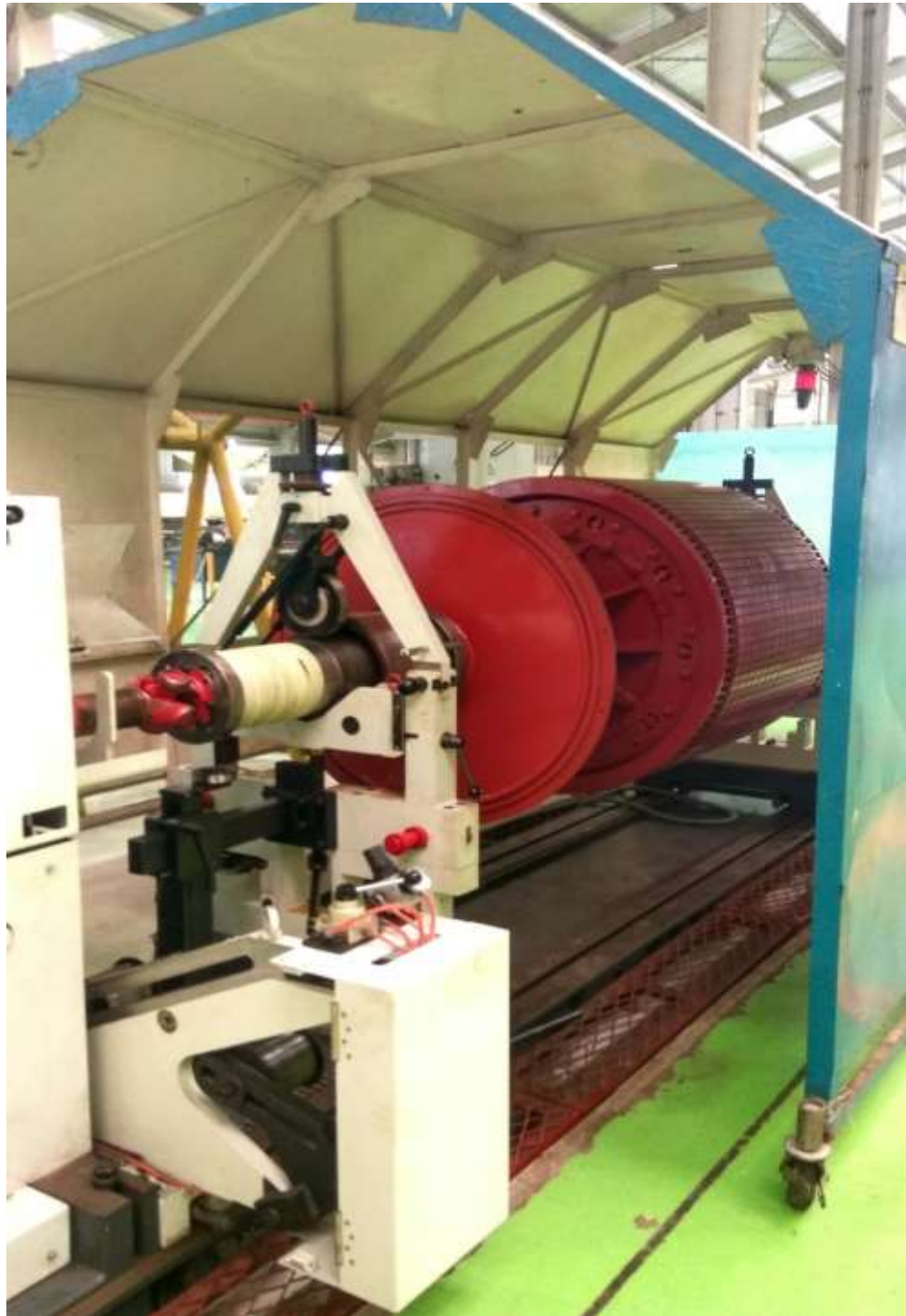
Lampiran 4. Pengujian UNBALANCING Pada Rotor Motor CWP
