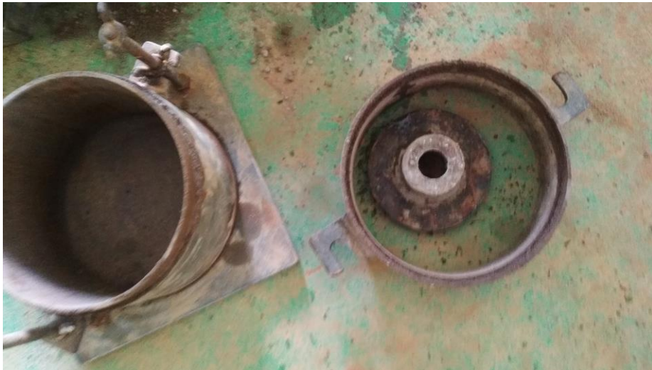
Gambar Tabung Uji Proktor Standar
