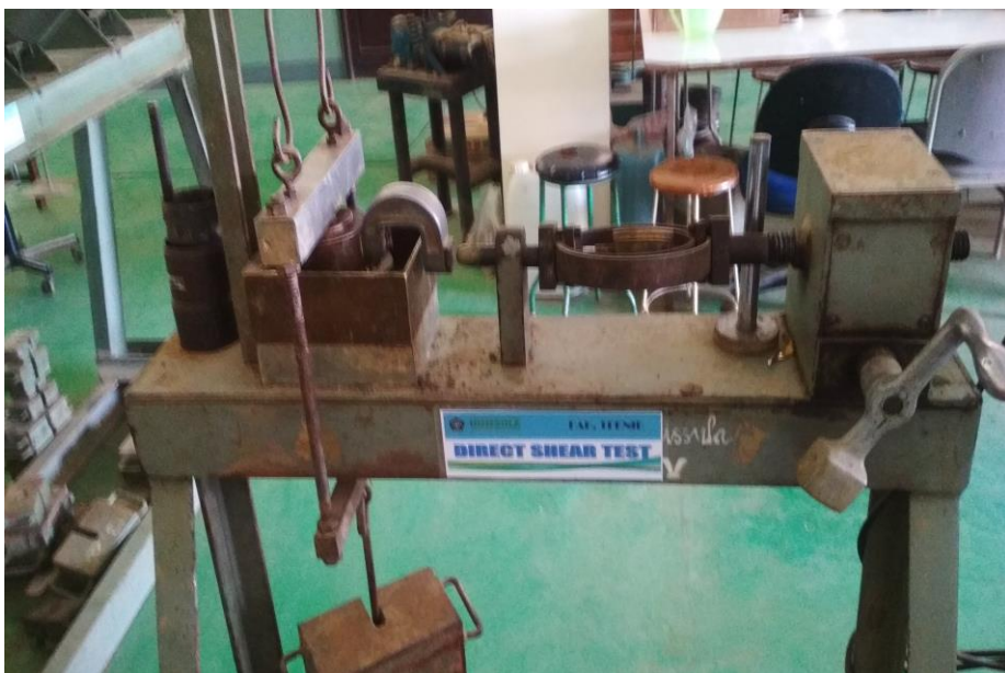
Gambar Benda Uji Geser Tanah
