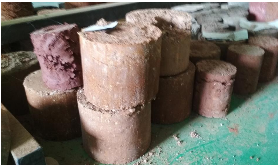
Gambar Tanah Setelah Di Masukkan Tabung Proctor Standar
