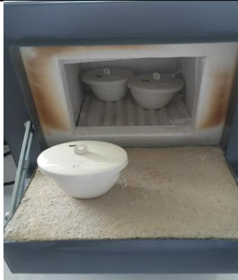
Krus + ekstrak di masukkan kedalam tanur yang bersuhu 600 \pm 25^\circ\text{C}
