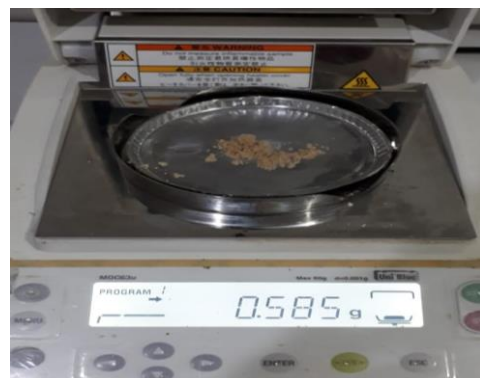
Gambar 21. Cek Kadar Air Isolat
