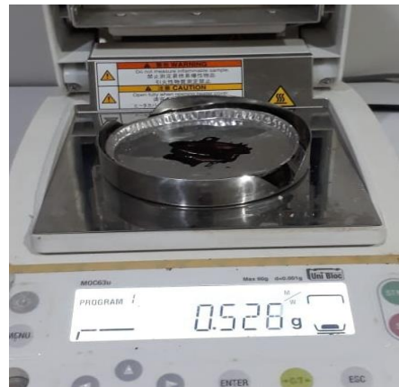
Gambar 19. Cek Kadar Air Ekstrak
