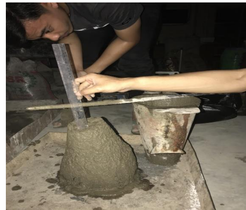
Pengukuran Uji Slump Test
