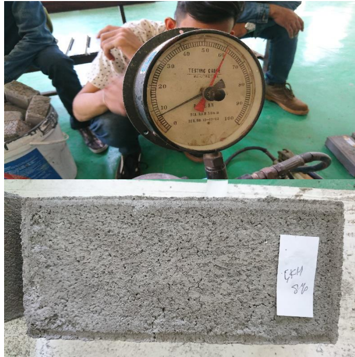
Gambar 15. Uji Kuat Lentur Cone Block Serbuk Kaca 8%
