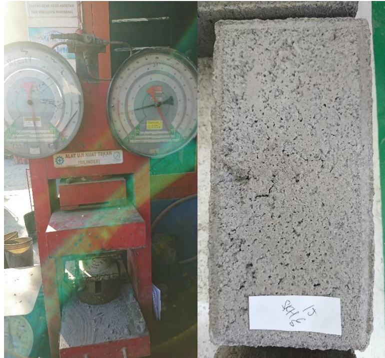
Gambar 7. Uji Kuat Tekan Cone Block Serbuk Kaca Hijau 15%
