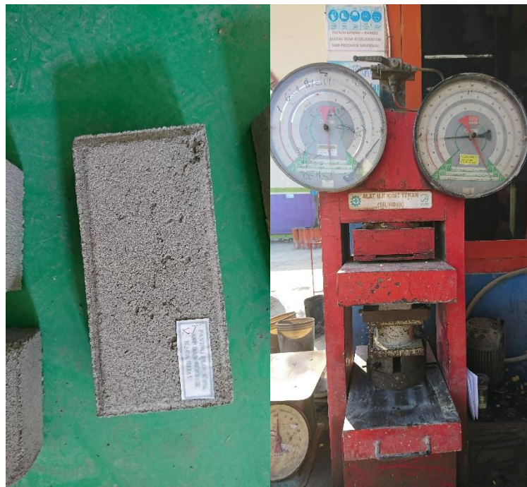
Gambar 29. Uji Kuat Tekan Cone Block ASP dan SKH 8%
