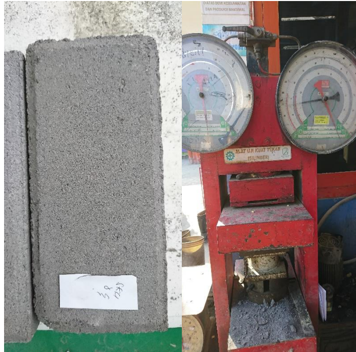
Gambar 28. Uji Kuat Tekan Cone Block Serbuk Kaca Hijau 15%
