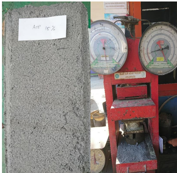
Gambar 25. Uji Kuat Tekan Cone Block Abu Sekam Padi 15%
