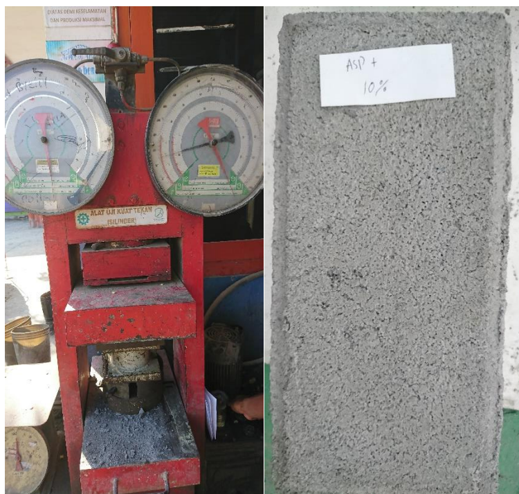
Gambar 3. Uji Kuat Tekan Cone Block Abu Sekam Padi 10%
