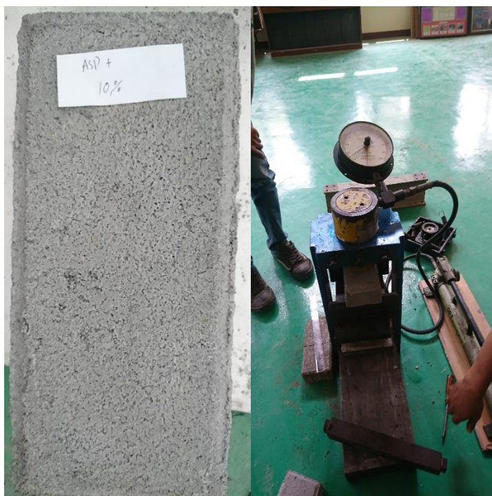
Gambar 13. Uji Kuat Lentur Cone Block Abu Sekam Padi 10%
