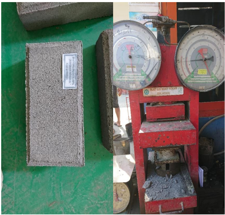
Gambar 30. Uji Kuat Tekan Cone Block ASP dan SKH 10%
