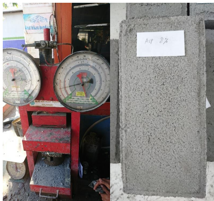
Gambar 2. Uji Kuat Tekan Cone Block Abu Sekam Padi 8%
