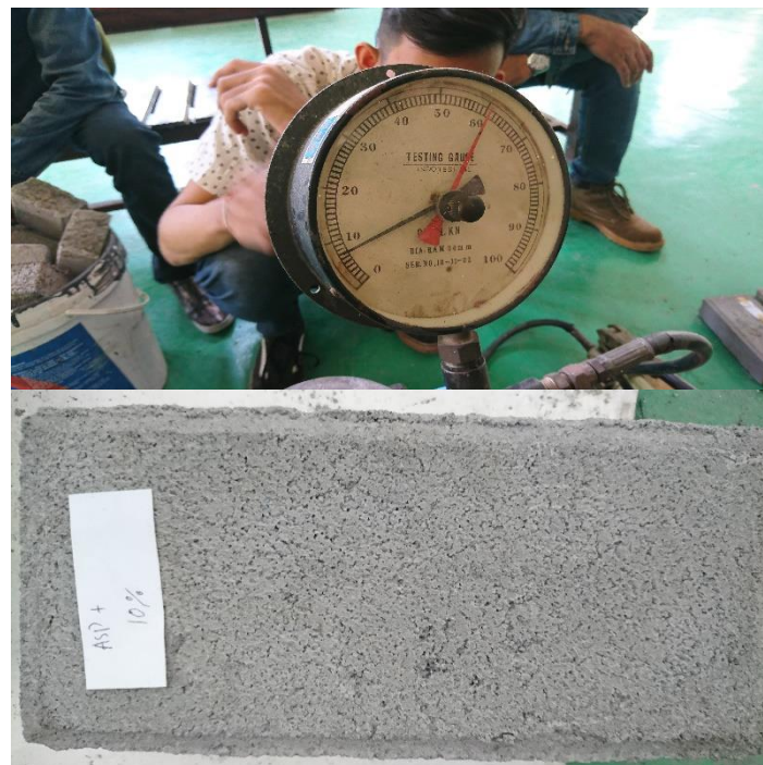
Gambar 16. Uji Kuat Lentur Cone Block Serbuk Kaca Hijau 10%
