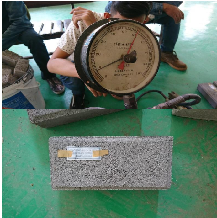
Gambar 40. Uji Kuat Lentur Cone Block ASP dan SKH 10%
