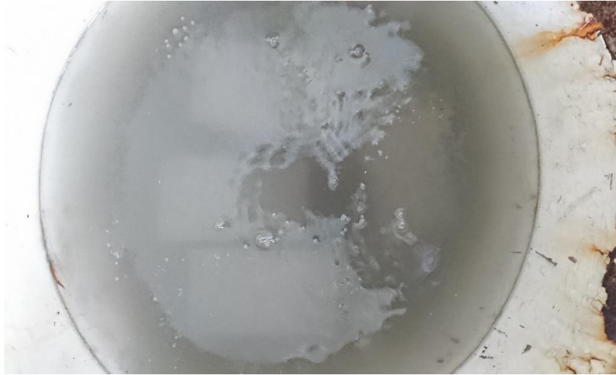
Gambar 42. Uji Daya Serap Air Cone Block Umur 14 Hari
