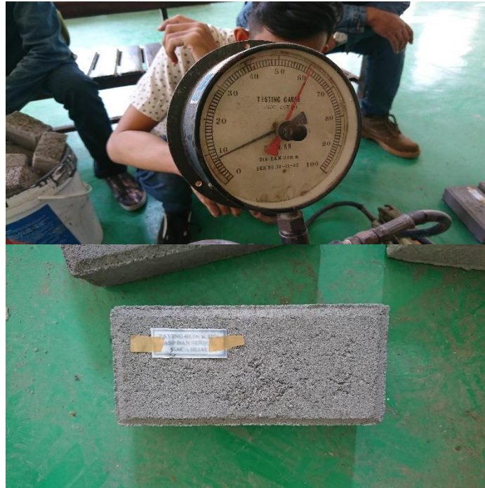
Gambar 19. Uji Kuat Lentur Cone Block ASP dan SKH 10%
