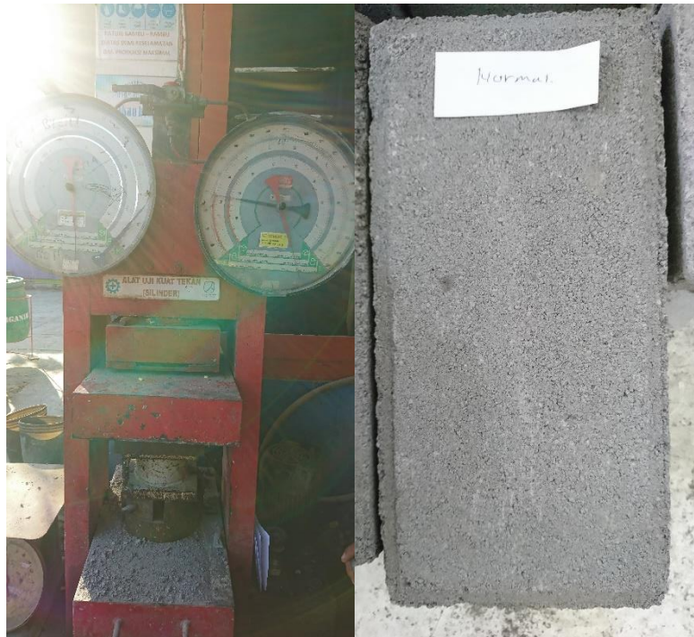
Gambar 22. Uji Kuat Tekan Cone Block Normal
