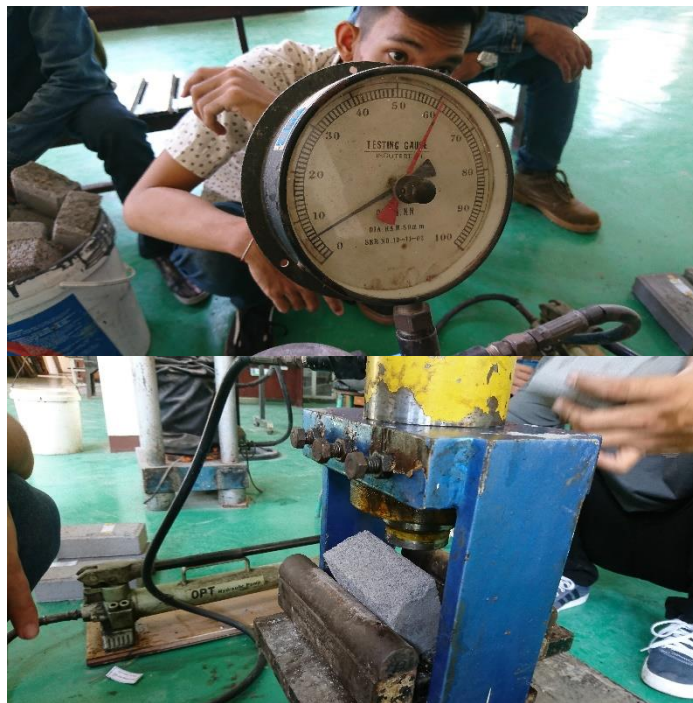
Gambar 35. Uji Kuat Lentur Cone Block Abu Sekam Padi 15%
