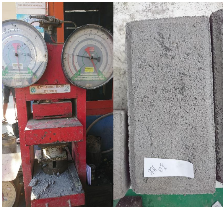
Gambar 27. Uji Kuat Tekan Cone Block Serbuk Kaca 10%
