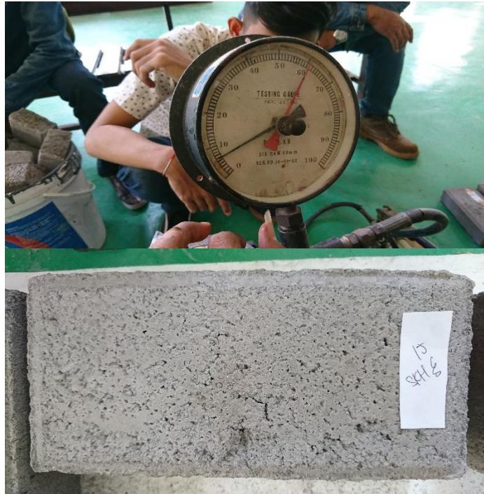
Gambar 38. Uji Kuat Lentur Cone Block Serbuk Kaca Hijau 15%
