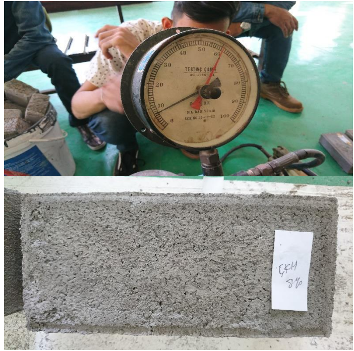
Gambar 36. Uji Kuat Lentur Cone Block Serbuk Kaca 8%
