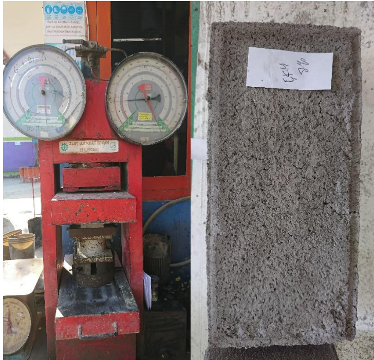
Gambar 26. Uji Kuat Tekan Cone Block Serbuk Kaca 8%
