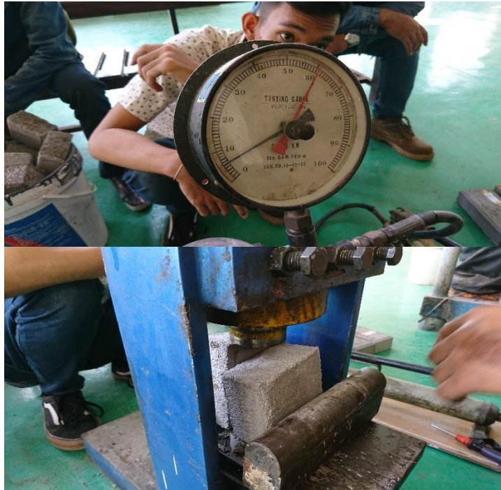
Gambar 34. Uji Kuat Lentur Cone Block Abu Sekam Padi 10%
