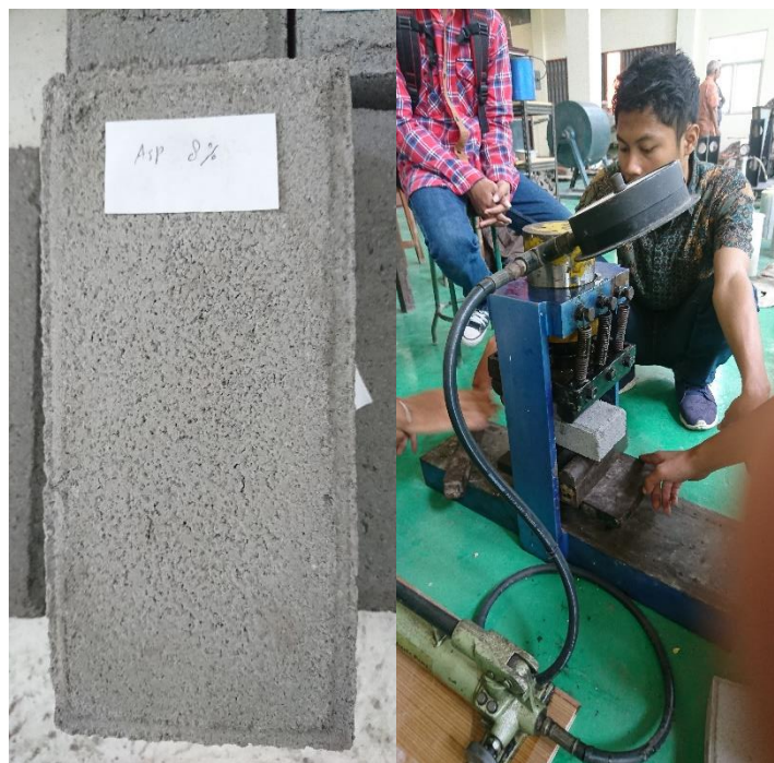
Gambar 12. Uji Kuat Lentur Cone Block Abu Sekam Padi 8%
