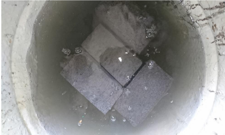
Gambar 21. Uji Daya Serap Air Cone Block Umur 7 Hari
