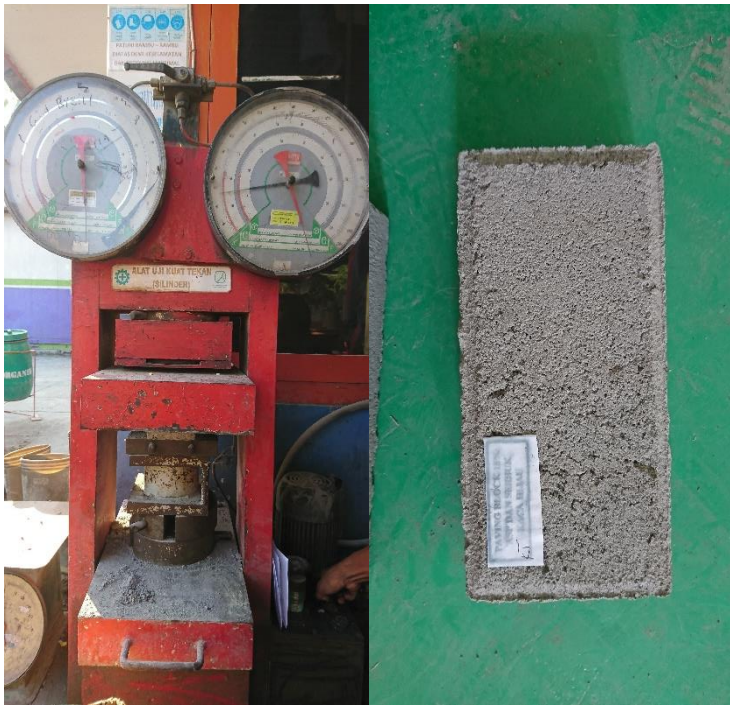
Gambar 31. Uji Kuat Tekan Cone Block ASP dan SKH 15%
