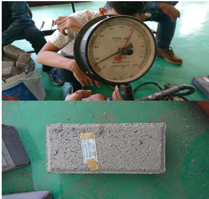
Gambar 41. Uji Kuat Lentur Cone Block ASP dan SKH 15%
