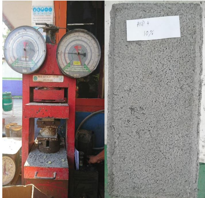
Gambar 24. Uji Kuat Tekan Cone Block Abu Sekam Padi 10%
