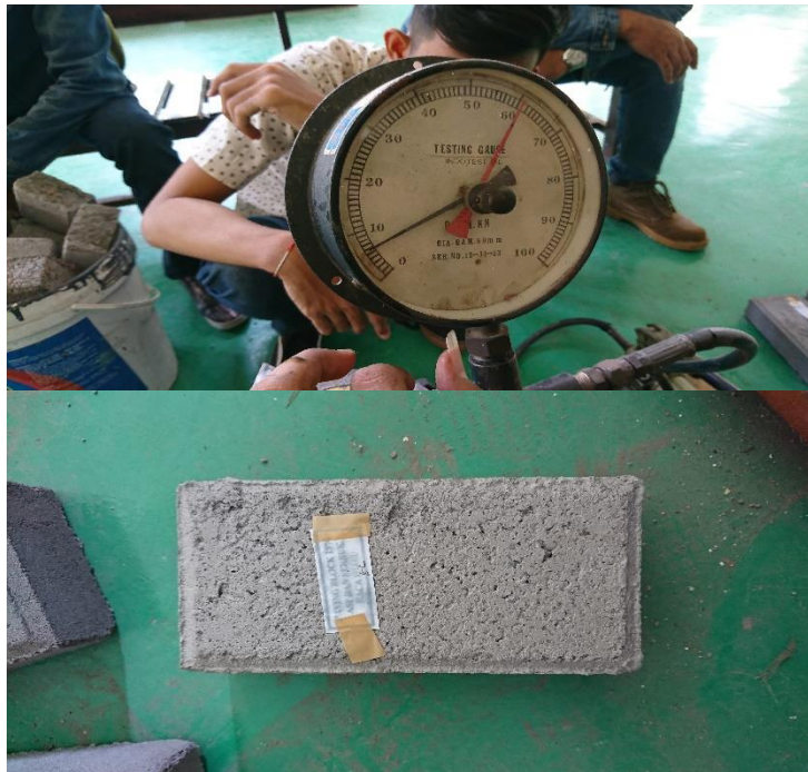
Gambar 20. Uji Kuat Lentur Cone Block ASP dan SKH 15%
