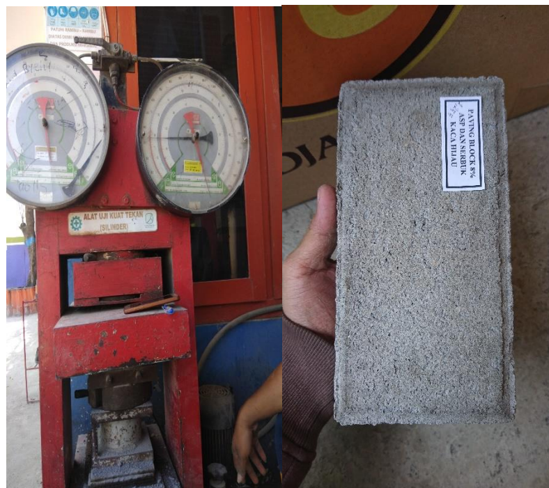
Gambar 8. Uji Kuat Tekan Cone Block ASP dan SKH 8%
