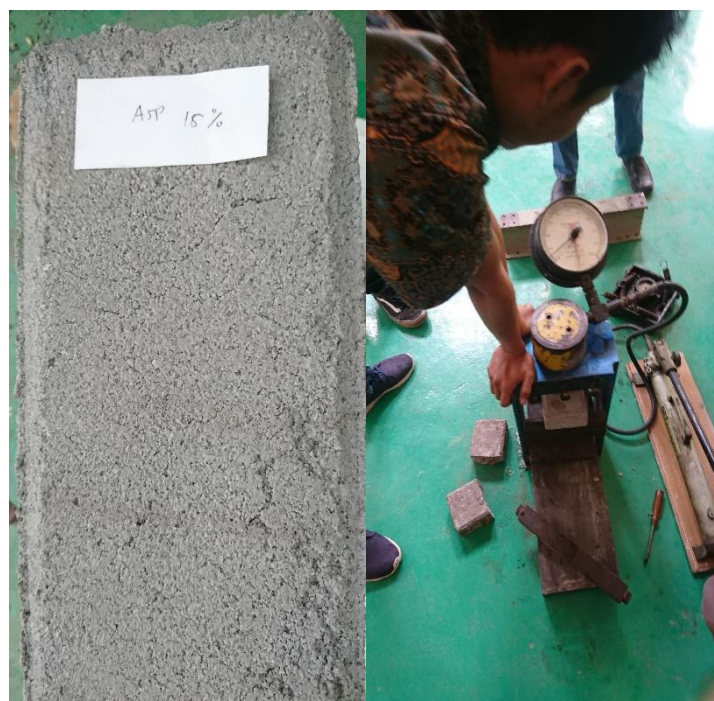
Gambar 14. Uji Kuat Lentur Cone Block Abu Sekam Padi 15%
