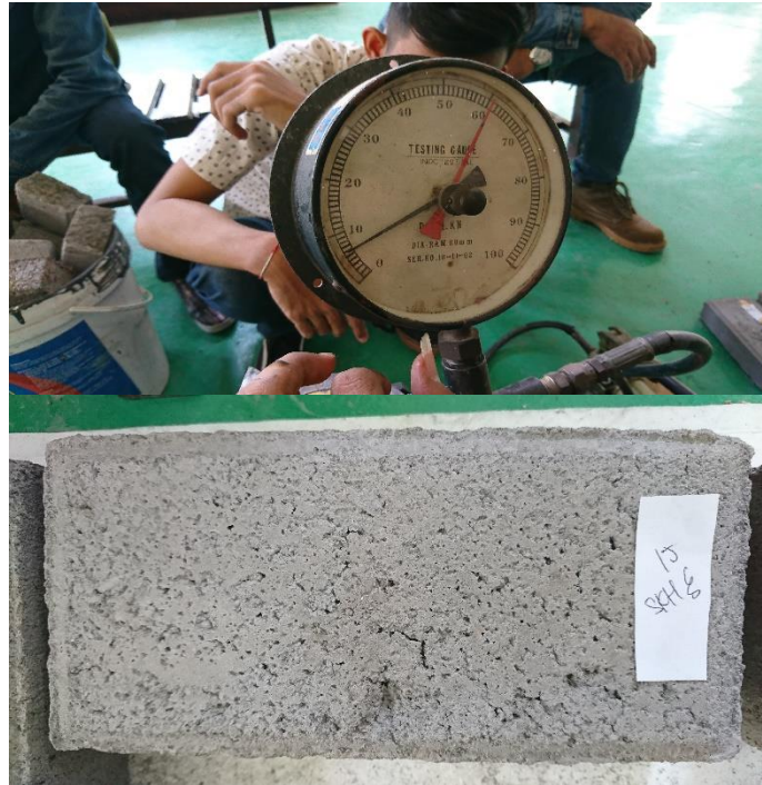
Gambar 17. Uji Kuat Lentur Cone Block Serbuk Kaca Hijau 15%
