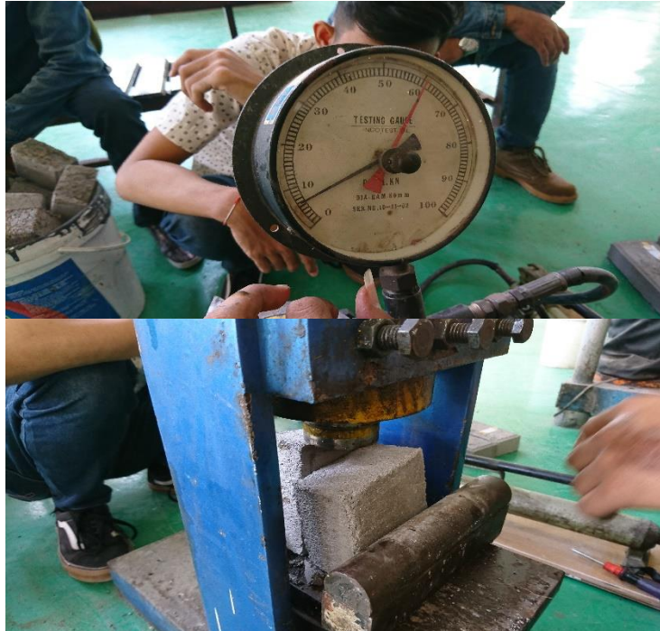
Gambar 33. Uji Kuat Lentur Cone Block Abu Sekam Padi 8%
