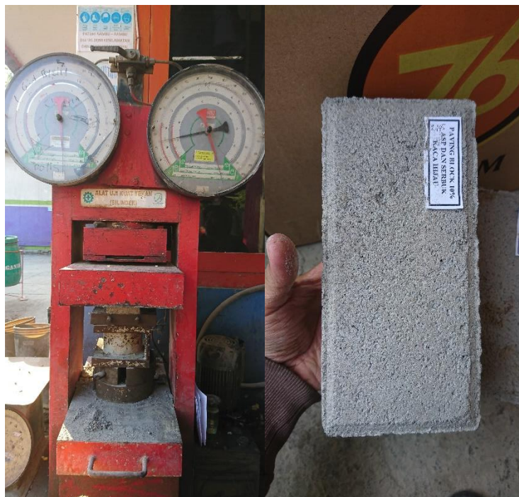
Gambar 9. Uji Kuat Tekan Cone Block ASP dan SKH 10%
