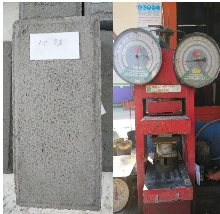
Gambar 23. Uji Kuat Tekan Cone Block Abu Sekam Padi 8%
