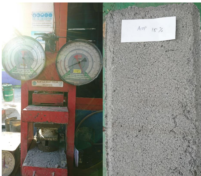
Gambar 4. Uji Kuat Tekan Cone Block Abu Sekam Padi 15%
