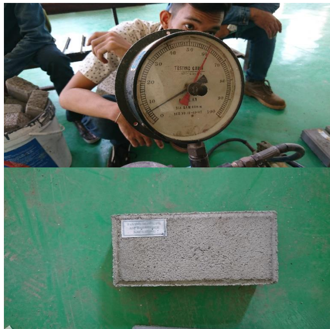
Gambar 39. Uji Kuat Lentur Cone Block ASP dan SKH 8%
