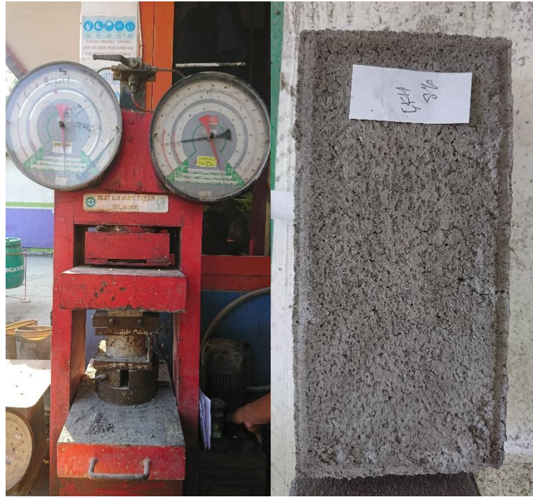
Gambar 5. Uji Kuat Tekan Cone Block Serbuk Kaca Hijau 8%
