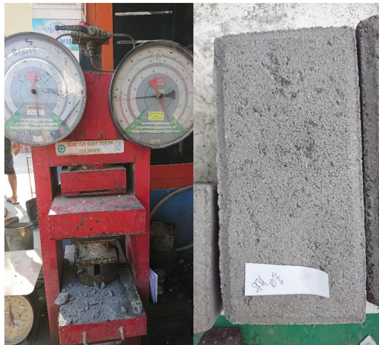
Gambar 6. Uji Kuat Tekan Cone Block Serbuk Kaca Hijau 10%
