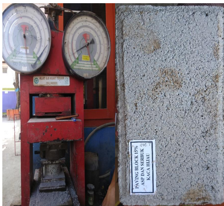
Gambar 10. Uji Kuat Tekan Cone Block ASP dan SKH 15%
