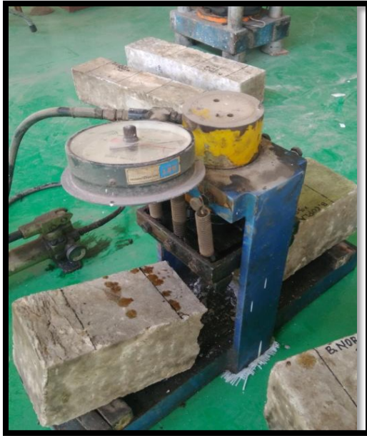
Gambar 9.1 Uji Kuat Lentur Balok
