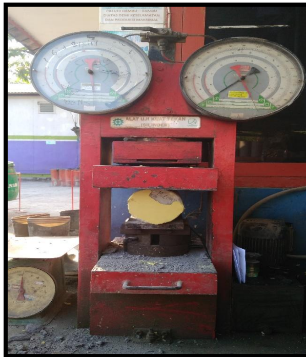
Gambar 4.2 Pengujian Kuat Tarik Belah Beton
