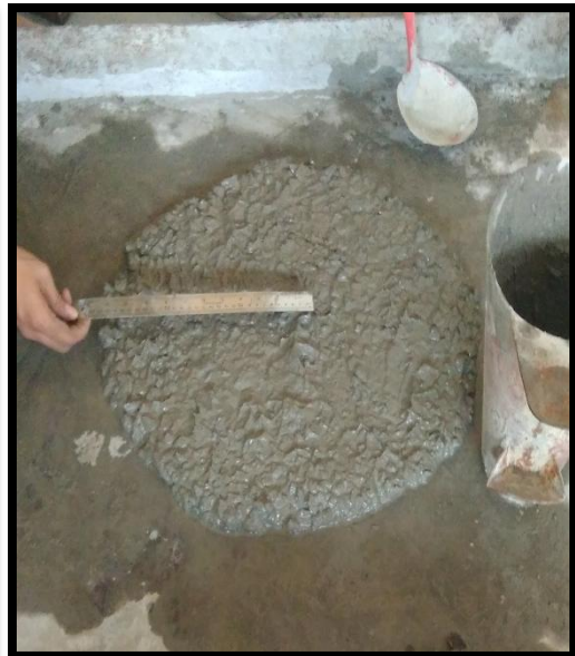
Gambar 6.2 (a) dan (b) slump flow test
