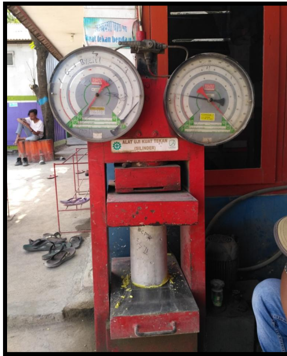
Gambar 4.1 Uji Kuat tekan Beton
