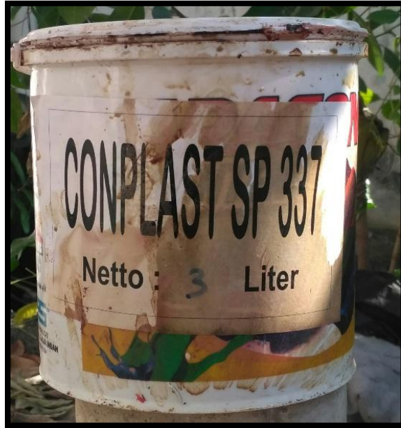
Gambar 3.1 Superplasticizer (conplast SP337)
