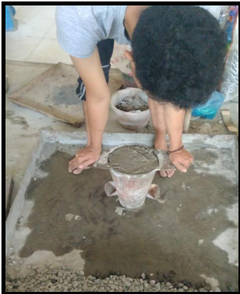
Gambar 6.2 (a) dan (b) slump flow test
