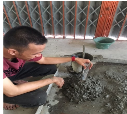
Pengukuran Uji Slump Test
