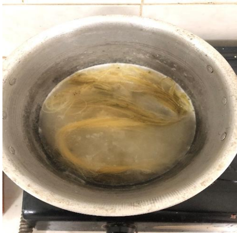
Serat direbus dalam larutan NaOH 6% dan dinetralisasi dengan larutan CH 3 COOH 6%
