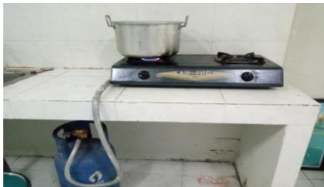
Gambar Proses Alkalisasi Fiber Sisal dan Fiber Nanas dengan Cara Direbus dengan Larutan NAOH 6% dengan Suhu 100°C Selama 1 Jam
