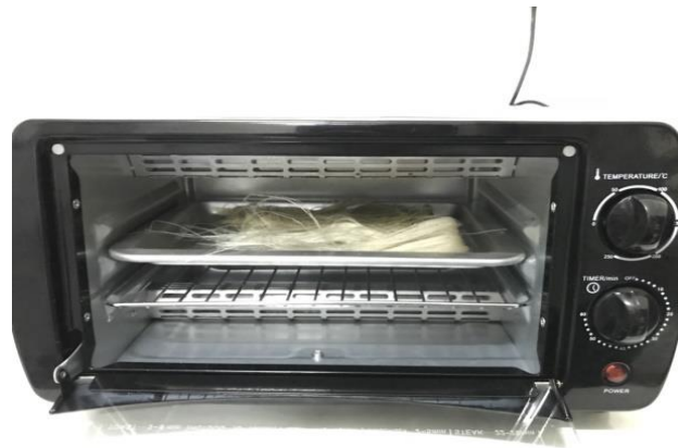
Gambar Proses Pengeringan Fiber Sisal dan Fiber Nanas Dimasukkan dalam Oven dengan Suhu 80^\circ\text{C} Selama 10 Menit
