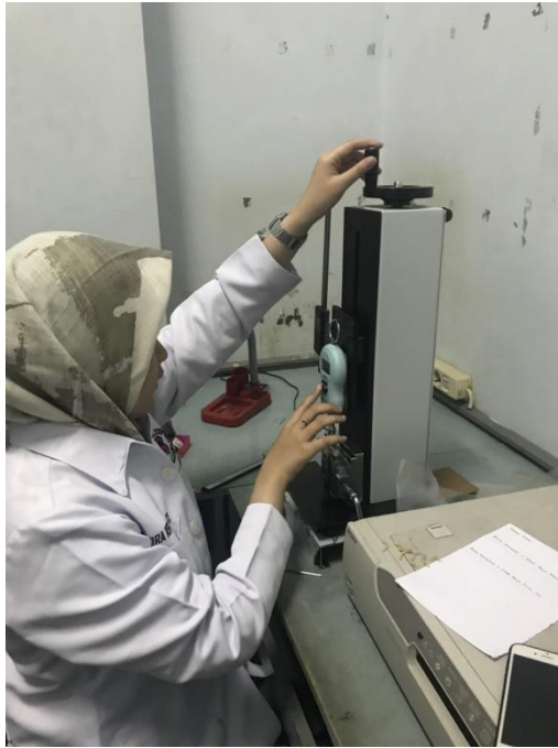
Gambar Spesimen Resin Komposit dengan Fiber Sisal dan Fiber Nanas saat dilakukan Pengujian Kekuatan Flexural
