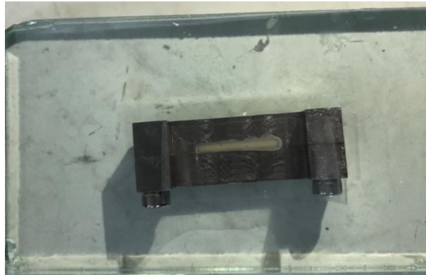
Gambar Aplikasi Resin Komposit diatas Fiber Sisal dan Fiber Nanas
