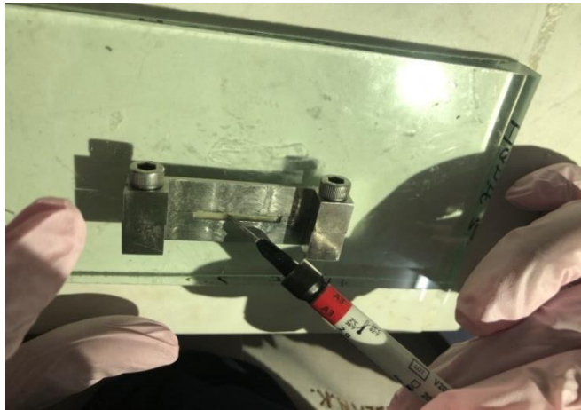
Gambar Aplikasi Resin Komposit dalam Pembuatan Spesimen Fiber Sisal dan Fiber Nanas
