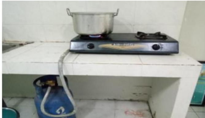
Gambar Proses Netralisasi Fiber Sisal dan Fiber Nanas dengan Larutan \text{CH}_3\text{COOH} 6% Pada suhu 100^\circ\text{C} Selama 1 Jam
