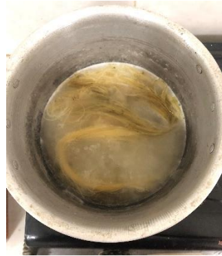
Serat di rebus dalam larutan NaOH 6%
