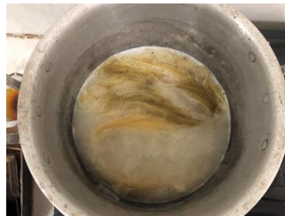
Serat direbus dalam larutan CH 3 COOH 6%
