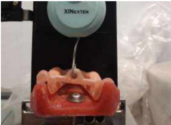
Uji retensi dengan UTM
