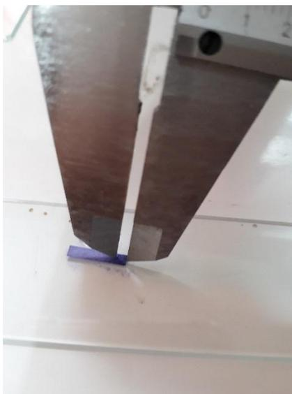
Pengukuran volume CSG dengan jangka sorong
