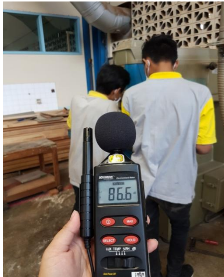
Pengukuran kebisingan dengan alat Sound Level Meter
