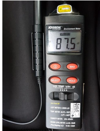
Pengukuran kebisingan dengan alat Sound Level Meter
