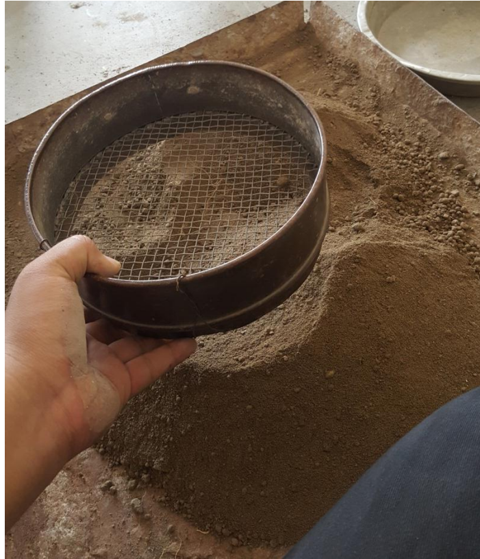
Menyaring Tanah dengan Saringan No. 40
