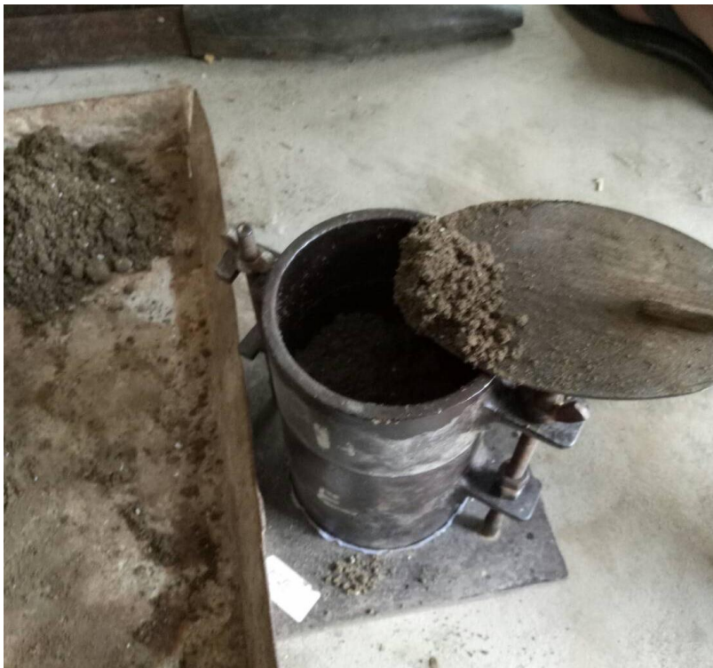
Pengujian Proktor Modified
