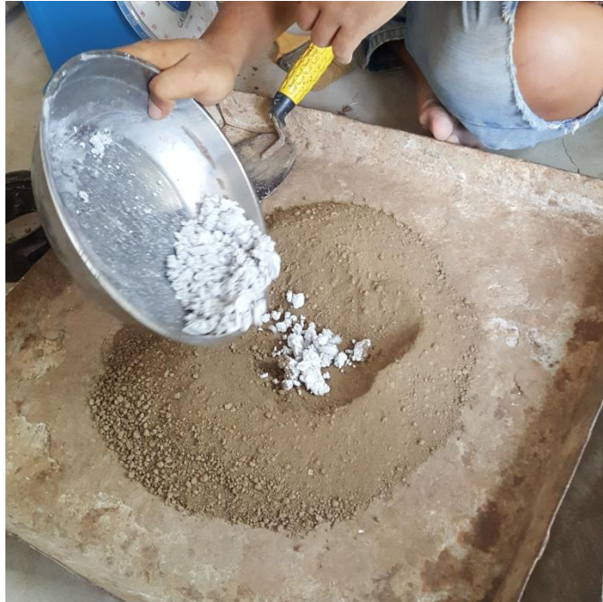
Penambahan Limbah Las Karbit Uji Proktor Modified
