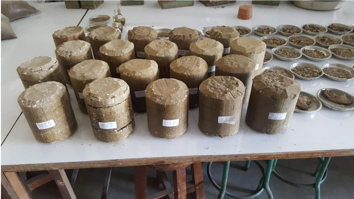
Pengujian Proktor Modified
