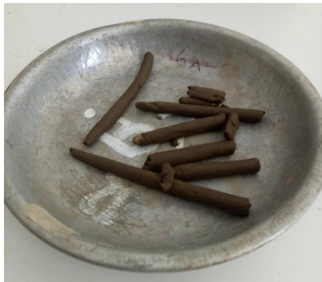
Pengujian Plastis Limit ( Batas Plastis )
