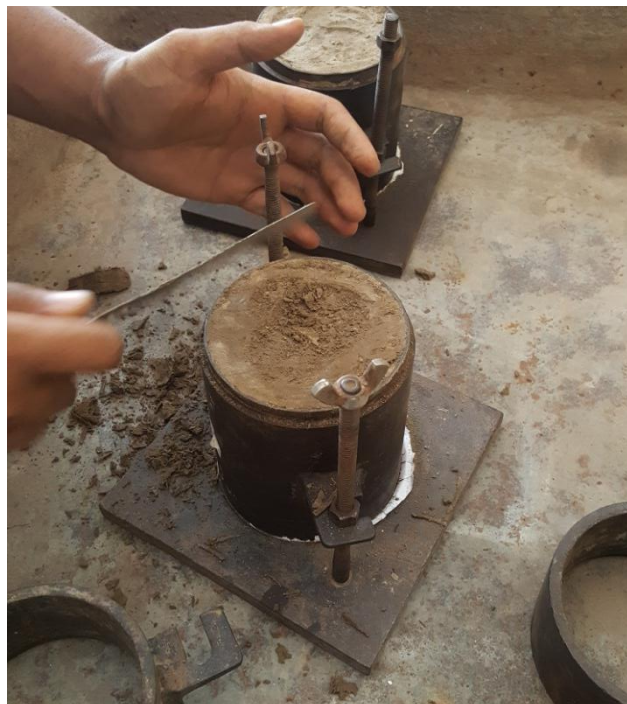
Pemerataan Mold Uji Proktor Modified
