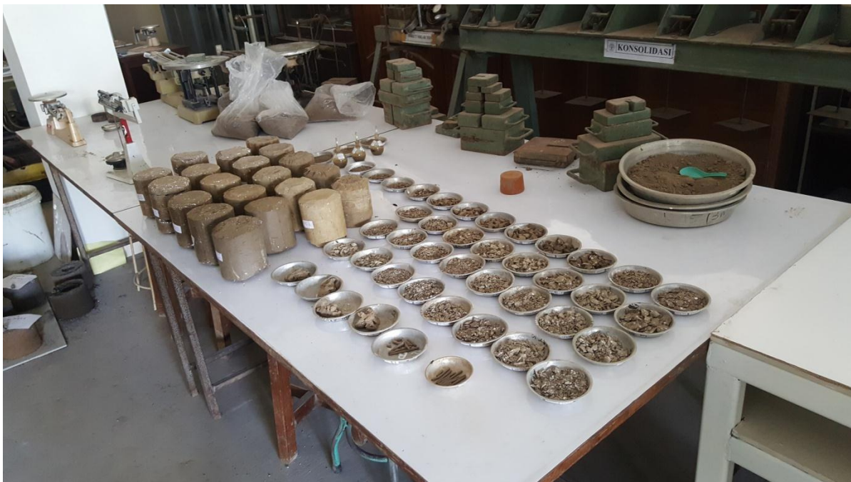
Pengujian Proktor Modified
