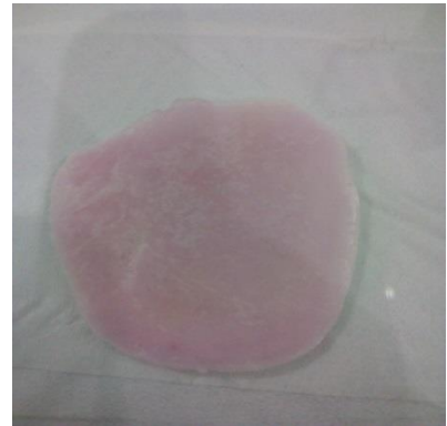
Kit setelah kering dengan konsentrasi mureksid 3000 ppm
