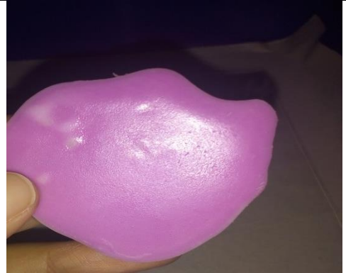
Kit setelah kering dengan konsentrasi mureksid 1000 ppm
