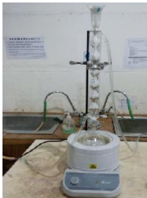
Keterangan : Saponifikasi dengan reflux
