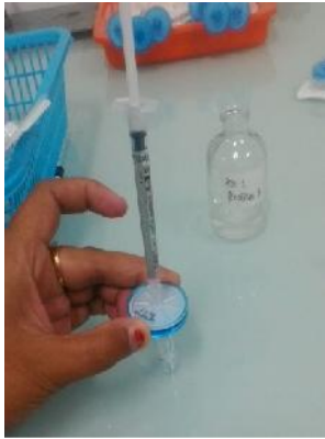
Keterangan : Penyaringan larutan residu
