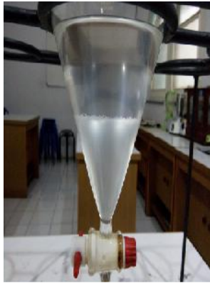
Keterangan : Ekstraksi dengan larutan KOH
