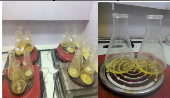
Gambar 7. Proses pemanasan saat destruksi
