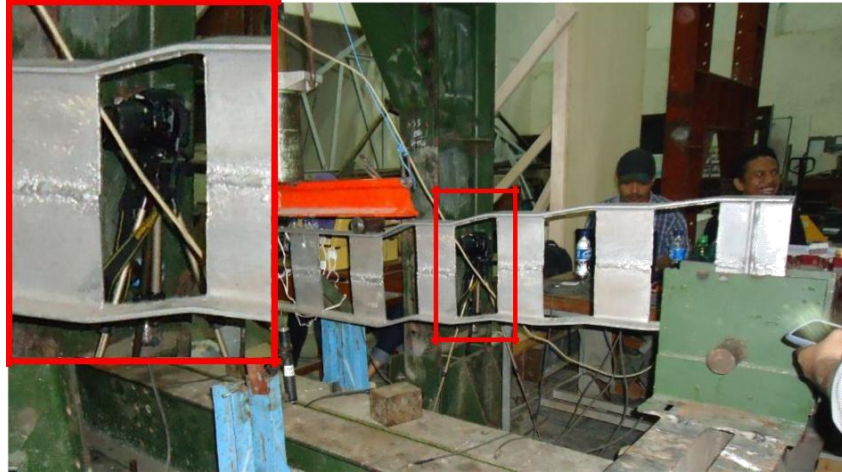
Gambar 1.2. Keruntuhan Vierendeel yang Terjadi Pada Balok Castellated Bukaan Segi Empat (Oliveira, 2012)
